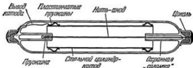
Рис. 23. Схематический разрез счетчика СТС-2.
