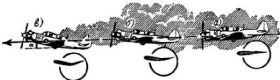
Рис. 21. Горизонтальный полёт с разными скоростями: а) максимальная скорость при очень малом угле атаки, б) — некоторая средняя скорость, в) — минимальная скорость при критическом угле атаки.
