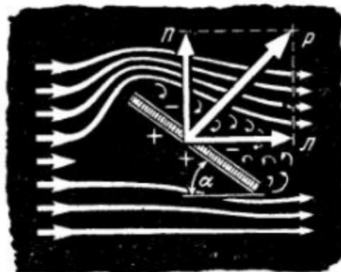
Рис. 12. Возникновение аэродинамической силы  $P$  при несимметричном обтекании пластины и замена силы  $P$  двумя аэродинамическими силами — подъёмной силой  $P$  и силой лобового сопротивления  $L$ .
