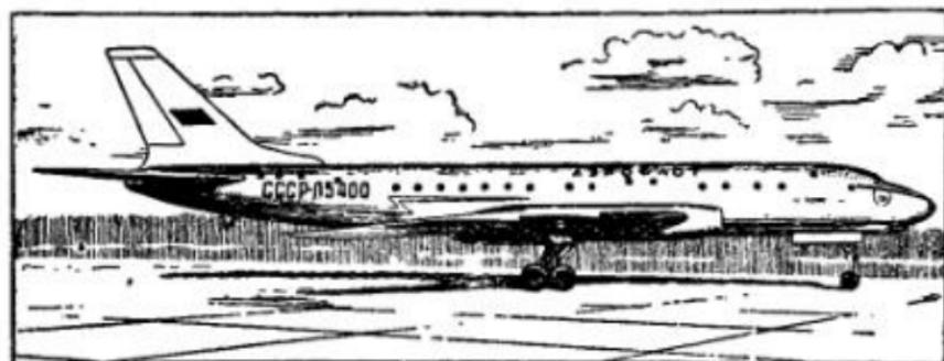
Рис. 32. Реактивный пассажирский самолёт ТУ-104 на 50 человек конструкции А. Н. Туполева. Скорость самолёта — 800 километров в час.
