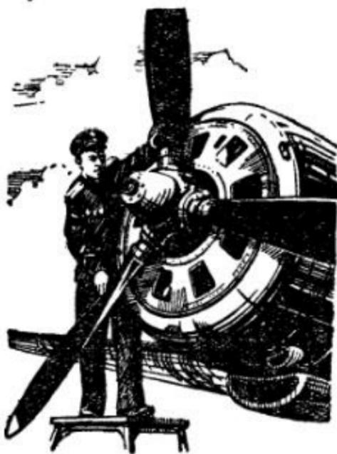
Рис. 18. Трёхлопастный воздушный винт изменяемого шага на пассажирском самолёте.
