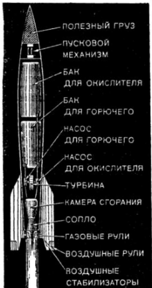
Рис. 6. Жидкостная ракета.
