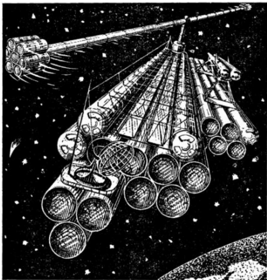
Рис. 11. Примерная конструкция искусственного спутника. В нижней части искусственного спутника царит невесомость; в верхней части спутника благодаря её вращательному движению ощущается искусственная тяжесть.
