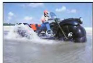
ли возможность познакомиться с трициклом «Самсон». Оборудованный двигателем с жидкостным охлаждением объемом 350 см<sup>3</sup> и мощностью 24,5 л. с., «Самсон» может легко двигаться по рыхлому снегу, песку, преодолевать болота и даже водные преграды.
