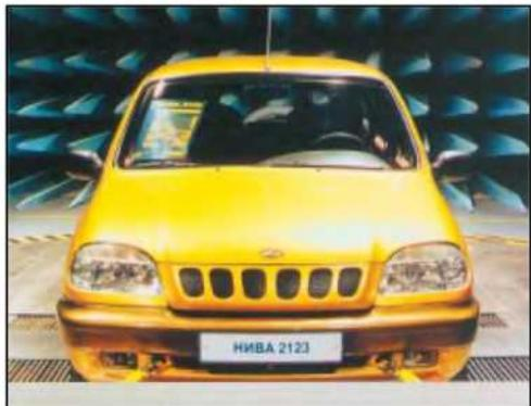
*Изучение электромагнитной совместимости электронных и электрических устройств нового автомобиля в безэховой камере.*
