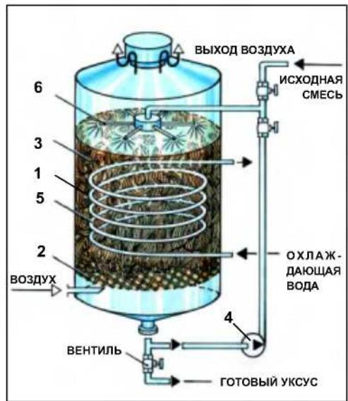
Рис. 2. Аппарат Фрингса: 1 — корпус; 2 — ложное перфорированное днище; 3 — слой буровых стружек; 4 — циркуляционный насос; 5 — змеевик системы термостатирования; 6 — распределительное устройство.
