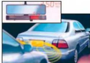
Серийно промышленностью выпускаются цифровые индикаторы тылового контроля тяжелых для автобусов, грузовиков, трейлеров; на них устанавливаются по две приемопередающие части с обеих сторон заднего борта.
