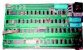
Так выглядел компьютер Apple I. Справа — его материнская плата.
