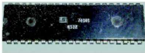
Сердце компьютеров Apple I и Apple II — микропроцессор 6502 MOS Technology.
