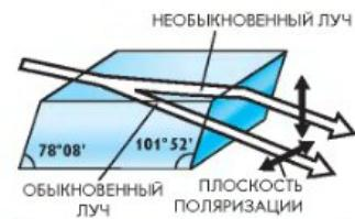
Луч света в кристалле исландского шпата расщепляется на два — обычный и необыкновенный (он преломляется даже при перпендикулярном падении на грань кристалла!). Свет в обоих лучах поляризован во взаимно перпендикулярных плоскостях.
