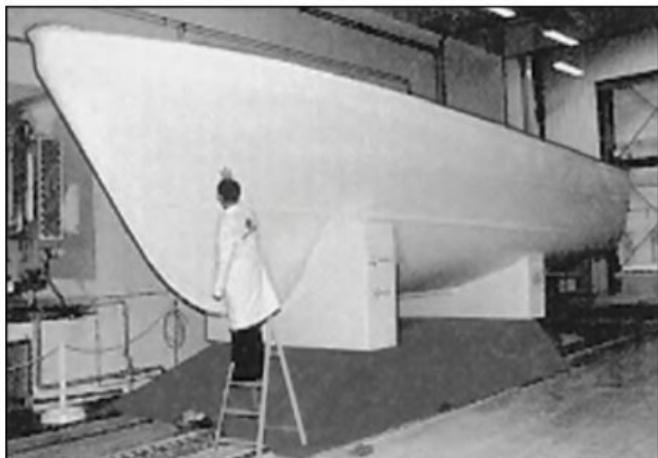
ной акриловой смолы со стекловолокном (см. фото), полимеризовали, проводя его под пучком электронов, выходящим из линейного ускорителя. Процесс в десять раз быстрее обычного и не требует катализаторов. Десять европейских фирм намерены сейчас изготавливать таким способом узлы и детали для вертолетов и сквозных поездов.
