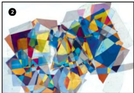
Кусочки цelloфана между скрещенными поляроидами превращаются в ярко раскрашенный витраж (2). Его цвета меняются на дополнительные, если один из поляроидов развернуть на  $90^\circ$  (3). Эти любопытные картины можно наблюдать в самодельный полярископ.
