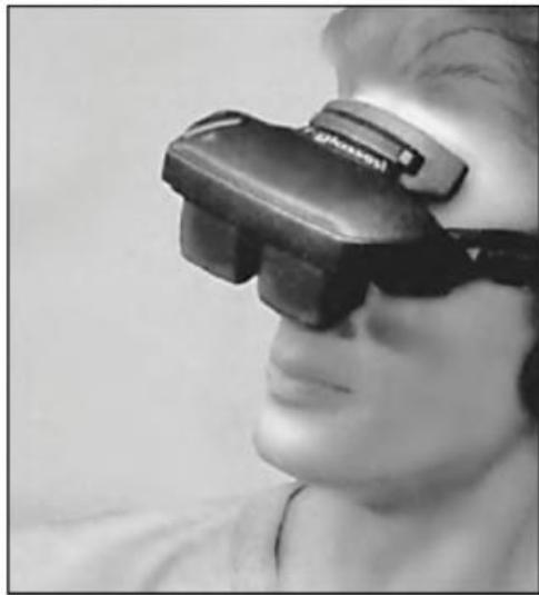
Очки с жидкокристаллическими фильтрами позволяют видеть на экране компьютера объемное изображение.
