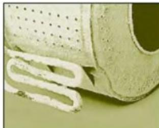
◀ Так выглядят нагревательный элемент и барабан стиральной машины без применения «Калгона».
