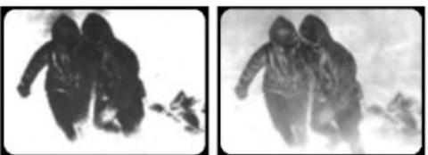
5. Темные фигуры на очень светлом фоне, снятые с автоматической регулировкой усиления, воспроизводятся в виде силуэтов (слева). Введение режима «beach & ski» позволяет разглядеть их детали (справа).
