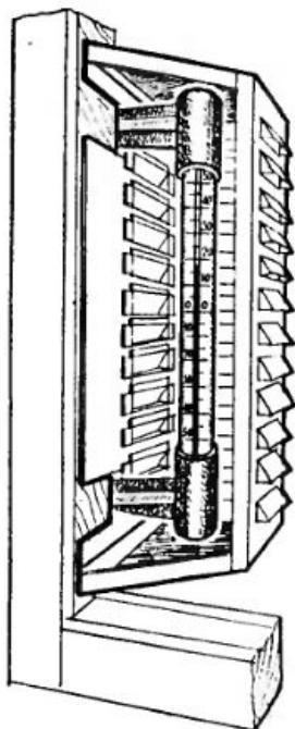
1 — большие жалюзи, 2 — малые жалюзи, 3 — нижняя крышка корпуса, 4 — винт для жалюзи.
