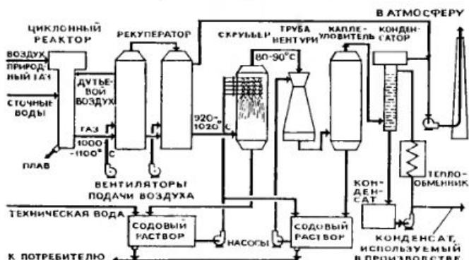
В производстве капролактама, да и во многих других технологических процессах, образуются стоки, содержащие наряду с органическими соединениями натриевые соли. После их огневого обезвреживания, в ходе которого выгорают органические соединения, необходима очистка образующихся газов от твердых частиц из солей натрия.
