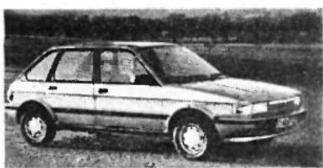
**«ОСТИН-МАЭСТРО»** (Англия). Начало выпуска — март 1983 года. Машина с передними ведущими колесами, без водосточных желобов над дверями. Рабочий объем двигателя — 1275 см<sup>3</sup>. Мощность — 69 л. с. (50,5 кВт) при 5800 об/мин. Длина машины — 4,0 м. Масса в снаряженном состоянии — 0,9 т. Число мест — 5. Скорость — 156 км/ч. Время разгона до 100 км/ч — 12,5 с. Расход топлива: 5,6—8,7—7,6 л/100 км.
