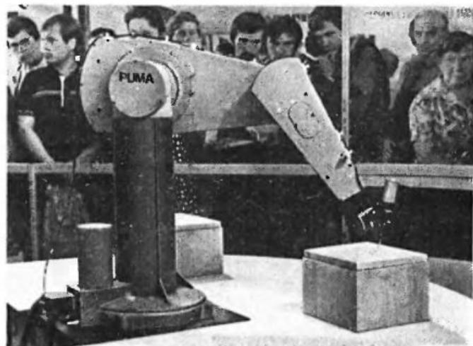
ния) сравним с человеческой рукой и при этом может выполнять работу значительно быстрее ее. Максимальная скорость перемещения у робота около 1,4 м/с, при этом движения его плавны и точны — отклонения позиций от запрограммированных не превышают 0,03 мм. При низкой скорости перемещений грузоподъемность робота составляет 5 кг, а при максимальной — 0,5 кг.
