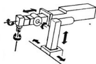
У руки робота 3 степени подвижности. Но число их можно увеличить до 5, используя дополнительные поворотные узлы. Стыковочный узел на торце кисти позволяет устанавливать сменные захваты. Манипулятор может оперировать с деталями массой до 2,5 кг и перемещаться (по направляющим, на роликах) со скоростью до 40 м/мин. Точность выполнения движений очень высока: отклонения не превышают 0,025 мм. Рука может оснащаться датчиком, информирующим об усилии сжатия.
