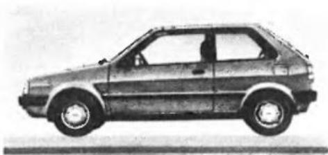
«НИССАН-МИКРА» (Япония). В Японии носит название «Ниссан-марч». У автомобиля передние ведущие колеса, зависимая задняя подвеска, подголовники сидений. Коэффициент лобового сопротивления — 0,39. Рабочий объем двигателя — 988 см<sup>3</sup>. Мощность — 57 л. с. (42 кВт) или 50 л. с. (37 кВт) при 6000 об/мин. Длина машины — 3,65 м. Число мест — 4. Масса в снаряженном состоянии — 0,67 т. Скорость — 145 км/ч. Расход топлива: 4,2—6,1—5,9 л/100 км.
