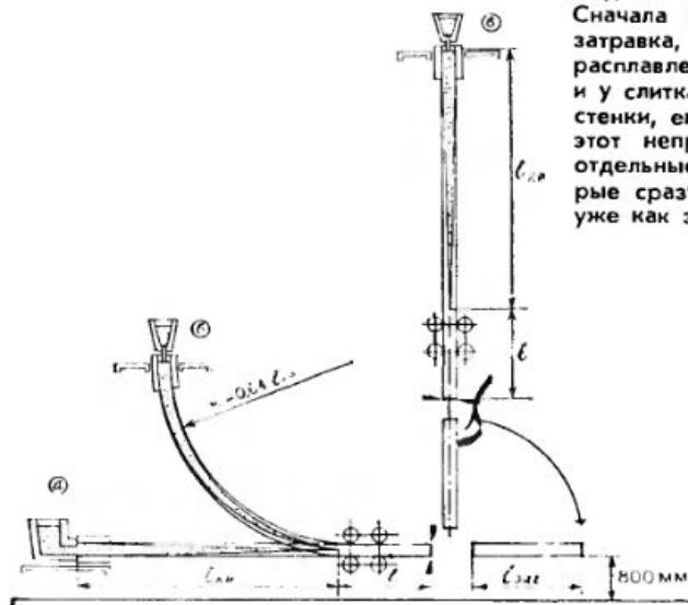
Сравнительная схема машин непрерывного литья заготовок: а — горизонтальной; б — радиальной; в — вертикальной;  $L_{\text{cr}}$  — длина зоны кристаллизации — она одинакова для всех трех типов машин;  $L$  — длина участка тяущих клетей и резки;  $R$  — радиус изгиба участка кристаллизатора и роликовых проводов;  $L_{\text{заг}}$  — длина отрезанной заготовки.
