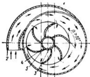
На рисунке — схематический разрез искрогасителя. 1 — «улитка», 2 — впускной патрубок, 3 — выпускной патрубок, 4 — направляющий аппарат, 5 — изогнутые лопатки.
