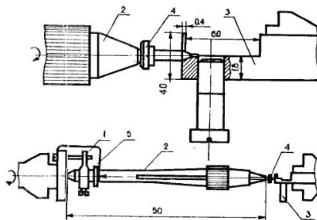
Приспособление для а) шлифовки и б) полировки цапф на токарном станке. 1 — Поводковое устройство, 2 — цанговые схемы, 3 — опора для цапфы, 4 — ось баланса, 5 — пружина.
