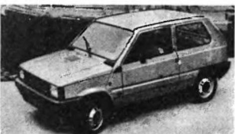
«ФИАТ-ПАНДА-45» (Италия). Как модификация базовой модели выпускается с октября 1982 года. Особенности конструкции: отсутствие дверных ручек, однощеточный стеклоочиститель, передние ведущие колеса. Рабочий объем двигателя — 903 см<sup>3</sup>. Мощность — 45 л. с. (33 кВт) при 5600 об/мин. Длина машины — 3,38 м. Число мест — 4. Масса в снаряженном состоянии — 0,68 т. Скорость — 140 км/ч. Время разгона до 100 км/ч — 18,5 с. Расход топлива: 5,0—7,0—7,1 л/100 км.
