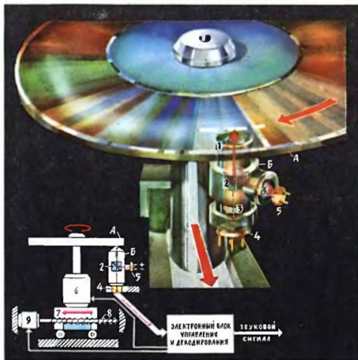
Схема устройства лазерного проигрывателя. А — оптическая цифровая пластинка (диск), Б — оптический звукосниматель, 1 — объектив, 2 — делительный кубик, 3 — линза, 4 — многоэлементный фотоприемник, 5 — лазерный диод, 6 — электродвигатель, 7 — подвижная каретка, 8 — червячная передача, 9 — электродвигатель.
