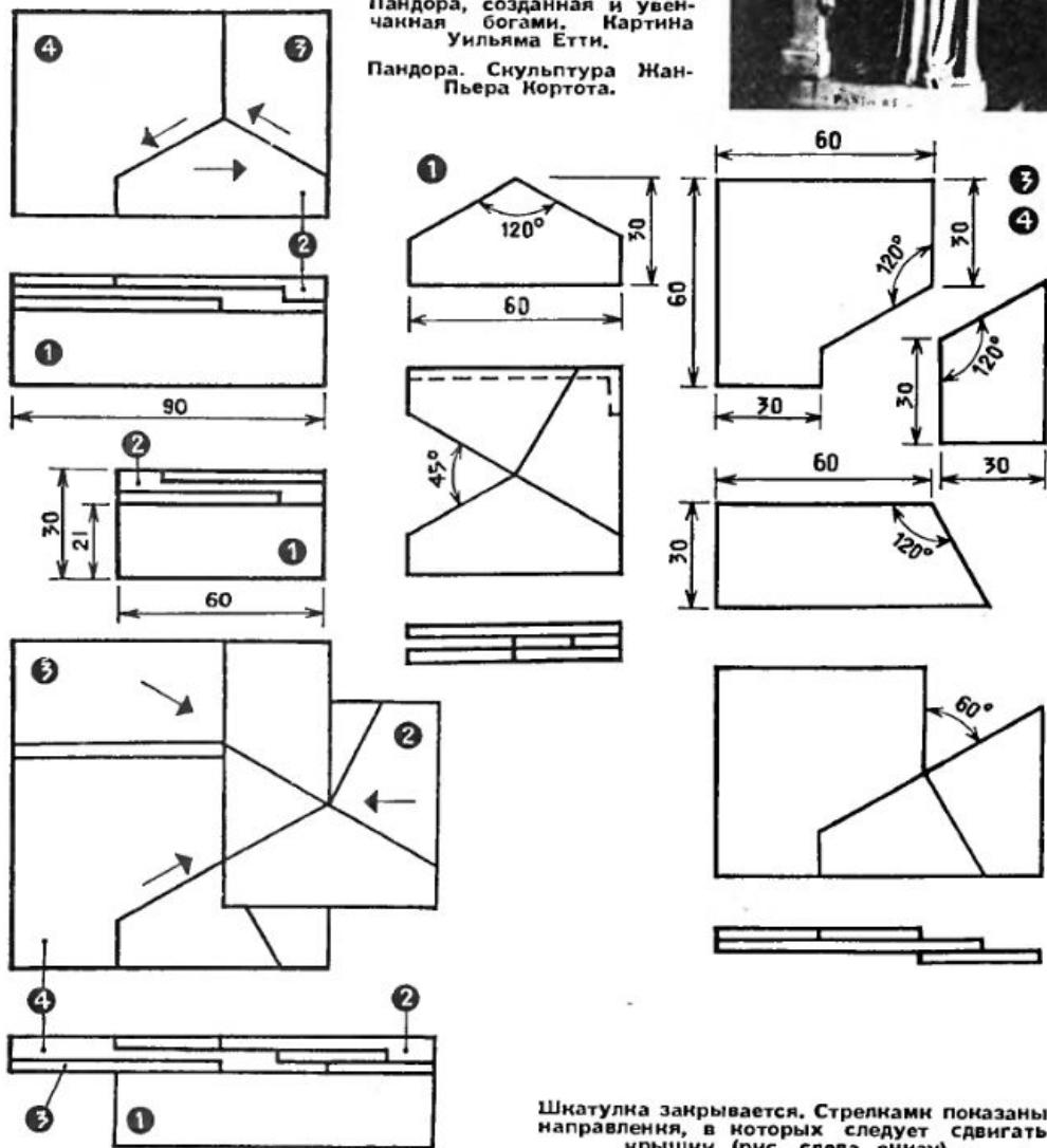
Шкатулка закрывается. Стрелками показаны направления, в которых следует сдвигать крышки (рис. слева внизу).
