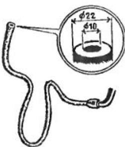
Для прочистки сливных труб в квартирах обычно используют стальной трос. И. Гадука (г. Чернигов) пишет, что он пользуется жестким резиновым шлангом диаметром 22 мм. Один конец шланга надо надеть на кран, а другим прочищать трубы. Горячая вода, пущенная по шлангу, помогает смыть грязь и жировые отложения.
