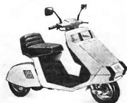
«ХОНДА-СТИМ» (Япония). Современная трехколесная конструкция с шарнирным соединением задних колес и машины, которое позволяет на поворотах наклонять мотороллер. Рабочий объем двигателя — 50 см<sup>3</sup>. Мощность — 3,8 л. с. (3 кВт). Масса машины в снаряженном состоянии — 90 кг. Скорость — 60 км/ч.
