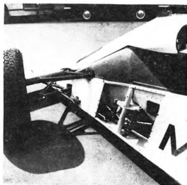
связи неподпрессоренных узлов с упругими элементами шасси. Такая система позволяет легко осуществлять необходимые регулировки для изменения характеристик подвески и положения кузова относительно дороги.
