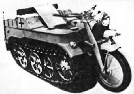
НСУ (Германия). Армейский полугусеничный мотоцикл — разновидность трицикла (1938 г.). У машины — расположенный сзади автомобильный двигатель, гусеница с транами на игольчатых подшипниках и резиновыми подушками, торсионная подвеска катков. Рабочий объем двигателя — 1478 см<sup>3</sup>. Мощность — 36 л. с. (26,5 кВт). Масса машины в снаряженном состоянии — 1233 кг. Длина — 3 м. Скорость — 80 км/ч.
