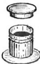
Чертежникам, художникам, ретушерам часто бывает нужно иметь при себе немного краски, туши и т. д. Отличная герметичная емкость для жидкости получается из двух полистиленовых пробок, плотно входящих друг в друга.
