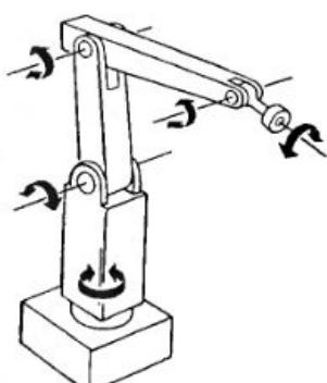
Адаптивный робототехнический комплекс с системой технического зрения; входившие в его состав роботы ТУР-10 имеют 5 степеней подвижности.
