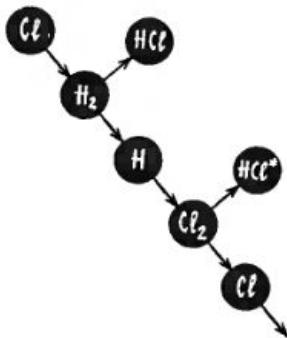
Как видно, химически активные атомы хлора и водорода все время возобновляются, так что на один атом, образованный вначале, можно получить много молекул хлористого водорода. Они оказываются колебательно-возбужденными (отмечено звездочкой) и могут быть использованы для генерации лазерного излучения.
