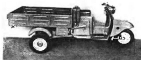
«МУРАВЕЙ-ТГА-200-КМ» (СССР). Машина грузоподъемностью 250 кг, созданная на базе мотороллера и сохранившая от него «верхнюю» посадку водителя. Задний ведущий мост имеет независимую подвеску колес и дифференциал. Рабочий объем двигателя — 199 см<sup>3</sup>. Мощность — 12 л. с. (9 кВт). Масса машины в снаряженном состоянии — 260 кг. Длина — 2,7 м. Скорость — 62 км/ч.
