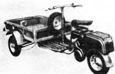
**«ЛАМБРЕТТА-125F» (Италия).** Грузовой трицикл на базе мотороллера (1949 г.). Грузоподъемность — 150 кг. Рабочий объем двигателя — 148 см<sup>3</sup>. Мощность — 6 л. с. (4,5 кВт). Масса машины в снаряженном состоянии — около 180 кг. Скорость — 45 км/ч.
