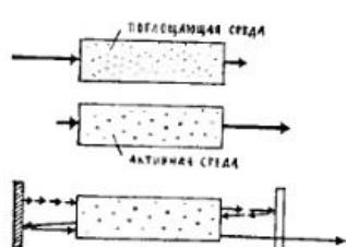
ся). Генерируемый в лазере луч благодаря зеркалам резонатора многократно проходит через активную среду и за счет этого усиливается во много раз.
