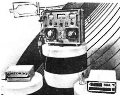
В ревматологии очень важно определять, насколько и какими шлаками «засорена» кровь. Быстрый и точный анализ ионного состава крови делает новый анализатор, который показан на этом снимке (слева — блок питания, справа — счетчик ионов).
