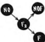
Как видно, в результате такого взаимодействия образуется атомарный фтор. Он инициирует цепную реакцию фтора с водородом, дающую колебательно возбужденные молекулы фтористого водорода. Этот способ был предложен в Физическом институте АН СССР в 1967 году.
