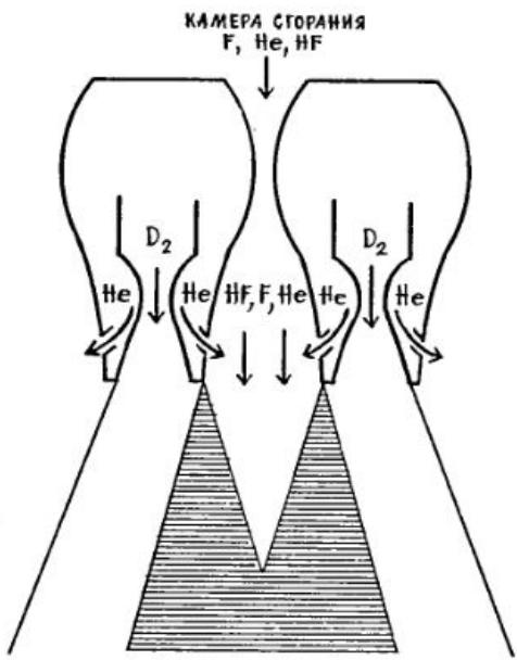
Чтобы хоть в некоторой мере представить многообразие и сложность проблем, стоявших перед создателями химических лазеров, рассмотрим лишь одну деталь лазера непрерывного действия с тепловым инициированием реакции дейтерия с фтором.
