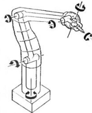
цесса. Привод манипулятора, работающего в цилиндрической системе координат, пневматический; система программного управления — цикловая. Все дополнительные звенья манипулятора работают по жестким упорам, в которые (кроме захвата) встроены датчики конечного положения; на модуле поворота установлены гидравлические демпферы.
