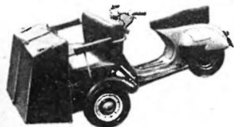
**«ВЯТКА-МТ150» (СССР).** Трехместное мототакси на базе мотороллера (1959 г.). Ноги пассажиров защищены от непогоды откидными щитками. Рабочий объем двигателя — 148 см<sup>3</sup>. Мощность — 5,5 л. с. (4 кВт). Масса машины в снаряженном состоянии — около 200 кг. Скорость — 35 км/ч.
