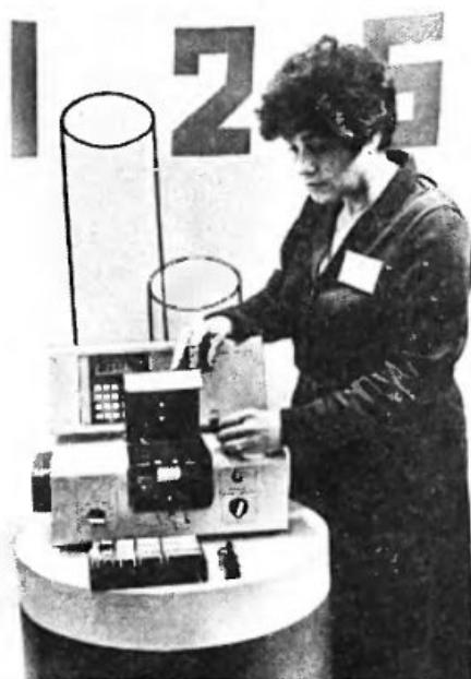
Калориметр, который вы видите на снимке, предназначен для клинических анализов крови. У пациента, как обычно, берут кровь из пальца, но не для каждого анализа отдельно, а только одну небольшую дозу. Пробирочку с кюветой (они в руке у стоматолога) помещают в аппарат и на пульте управления (он виден слева) дают задание произвести тот или иной анализ. Прибор автоматически выполняет все анализы.
