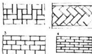
Схемы укладки покрытий из кирпича. 1 — попеременными рядами, 2 — «зигзагом» с бордюром, 3 — в шахматном порядке плашмя, 4 — кладка на ребро.
