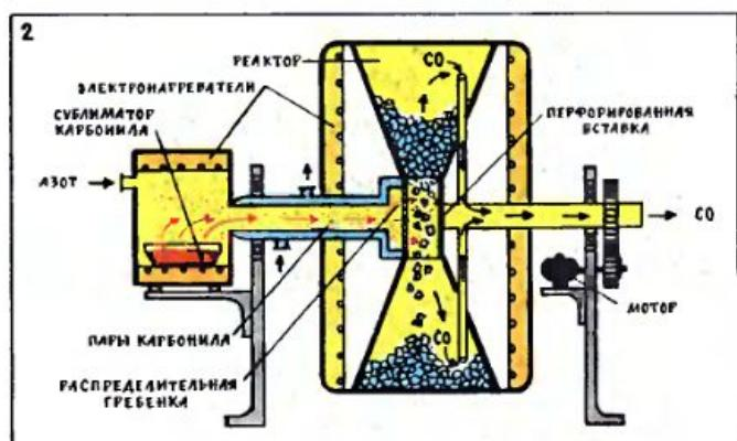
В верхний конус реактора загружаются частицы порошка и нагреваются там. Металлизация частиц происходит в момент соприкосновения их с парами карбонила в горловине реактора. При необходимости испуск реагтора поворачивается на 180°, и металлизация продолжается.
