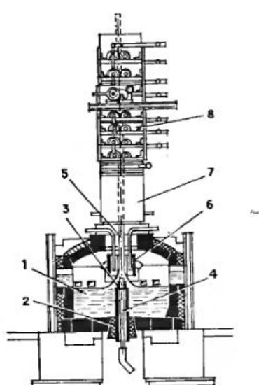
Схема установки для вертикального вытягивания стеклянных труб. Жидкая стекломасса выпускается из варочной печи в круглую рабочую камеру 1, в центре которой установлена графитовая втулка 2, не смачивающаяся стеклом. Во втулку вставлен шамотный мундштук-насадка 3 с трубкой 4 из нержавеющей стали; по ней в вытягиваемую трубу подается воздух. Готовая стеклянная труба 5 проходит через кольцевой холодильник 6 и холодильную шахту 7 и подается наверх машиной вертикального вытягивания 8.
