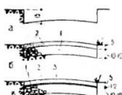
Засыпные дорожки из шлака, щебня, строительных отходов: а) профиль выемки, б) дорожка из шлака. 1 — основание (крупный шлак), 2 — покрытие (мелкий шлак с крупнозернистым песком); в) дорожка из щебня и строительных отходов. 1 — основание (доломит, бой кирпича, крупная галька и т. п.), 2 — гидроизолирующий слой (жирная глина 1—2 см), 3 — покрытие (щебенка, мелкий доломит, шлак с крупнозернистым песком).
