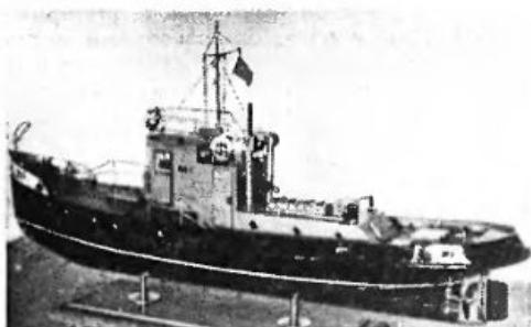
Модель первого в СССР цельносварного судна — буксирующего катера (типа «ЖС»), построенного на Дальзаводе в 1930 году; проектирован катер инженеры Р. А. Гребенников и Т. Т. Голицын.
