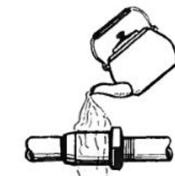
Слесарь В. Шубинцев (г. Уфа) пишет, что прежде чем прогревать огнем паяльной лампы неподдающиеся детали водопроводных соединений — трубы, муфты, краны — можно попытаться сгребнуть их, полив на резьбу кипятком из чайника.
