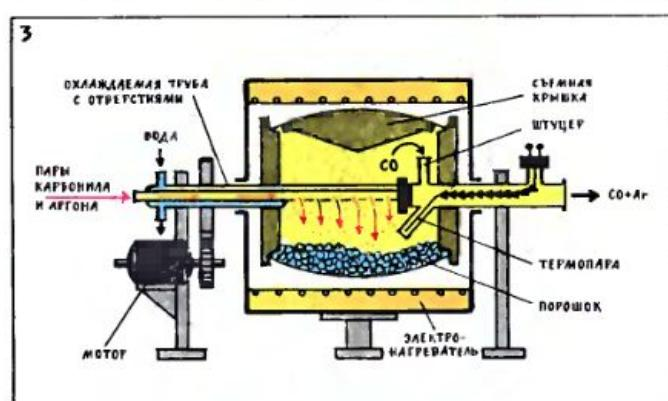
Частицы порошка засыпаются в барабан, нагреваются и металлизируются в парах карбонила металла при медленном вращении барабана.
