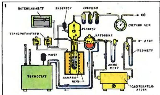
Инертный газ, захватывая пары нагретого карбонила металла, входит в нижнюю часть реактора, создавая «кипение» предварительно загруженных сюда зерен алмаза. На поверхности нагретых зерен происходит разложение карбонила и осаждается прочная пленка металла. Выделяющийся углерод возвращается на стадию синтеза карбонила металла.
