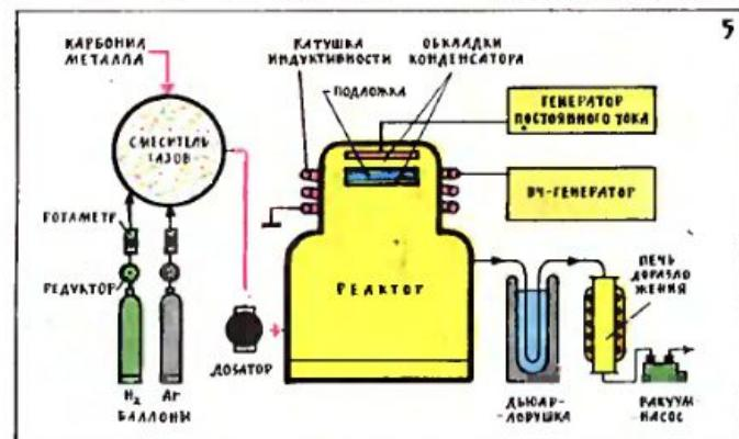
**ТЕХНОЛОГИЧЕСКАЯ СХЕМА ЭЛЕКТРОННО-ЛУЧЕВОЙ МЕТАЛЛИЗАЦИИ ПОДЛОЖЕК С ПОМОЩЬЮ КАРБОНИЛА.**
