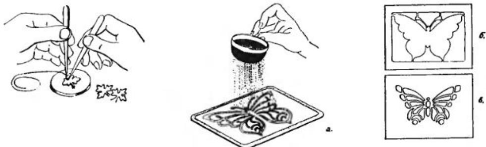
Изготовление однотипных деталей из сканни с помощью шаблона.
