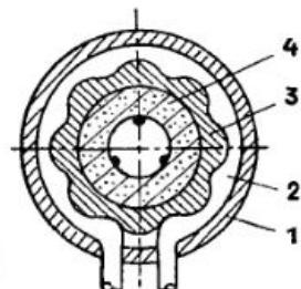
Высокочастотные колебания пьезокольца приводят в действие ротор, а он своими волнобразными выпуклостями прогоняет по трубке жидкость. Изменяя частоту колебаний кольца, можно плавно и с высокой точностью регулировать количество перекачиваемой жидкости.
