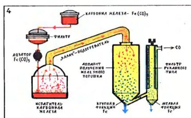
Жидкий карбонил железа переводится в парообразное состояние. Пары карбонила в свободном объеме реагатора нагреваются до 280° С и разлагаются в газовой фазе с образованием мельчайших частиц карбонильного железа, имеющих «луковичное» строение и обладающих поэтому высокими электромагнитными свойствами.
