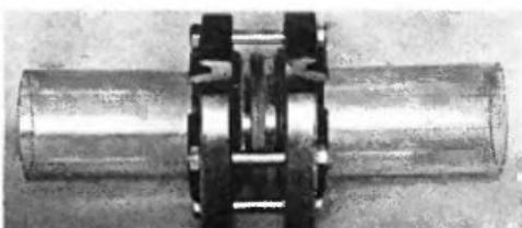
болтовое (муфто-резьбовое) соединение труб с гладкими концами. Такие соединения применяют для трубопроводов невысокого давления. Ниже — фланцевые соединения труб с буртами, для трубопроводов повышенного давления.
