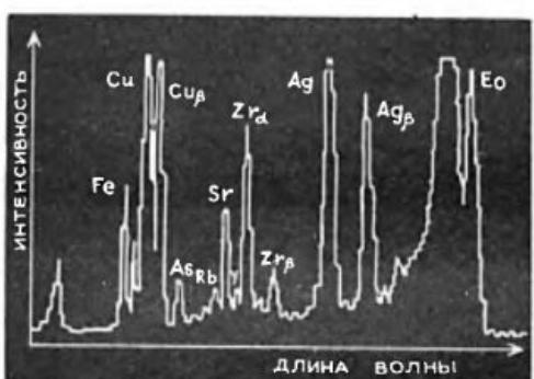
Результаты панорамного рентгенофлюоресцентного элементного анализа руды Удонанского месторождения. По горизонтали отложена энергия флюоресцентных квантов, однозначно определяющая, какие элементы присутствуют в образце, по вертикали — интенсивность флюоресцентного излучения, говорящая о концентрации элементов.
