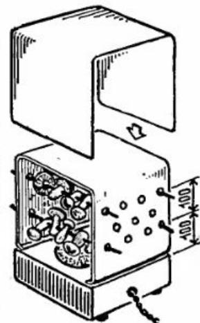
В. Пискарев (г. Москва) предлагает еще один способ сушки грибов. Нужно сделать из листового металла две П-образных детали. В боковых стенках одной просверливаются по 11 отверстий, в которых будут держаться шпажки с нанизанными грибами. Эта деталь ставится на электроплитку и закрывается другой деталью. Температура сушки регулируется переключением режимов электроплитки.
