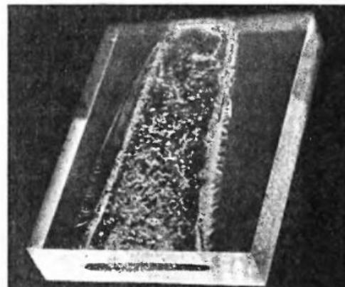
Пластина из оргстекла, в которой за одну-две минуты пучок рентгеновского СИ мощностью 1 ниловатт проплавил щелевое отверстие шириной 5 сантиметров, высотой 3 миллиметра на толщине 10 сантиметров. Этот пучок был получен в мае 1980 года на накопителе ВЭПП-3 с помощью специального генератора синхротронного излучения — сверхпроводящей «змейки».
