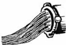
Когда предстоит замазать много стекол, например, при строительстве садового дома, желательно заготовить достаточно большое количество жгутиков из замазки. С. Несторов (г. Украинка) советует пропустить замазку через отслужившую свой срок мясорубку: получится много жгутиков одинакового диаметра. Такая подготовка сэкономит много времени, и работа будет выполнена аккуратно.
