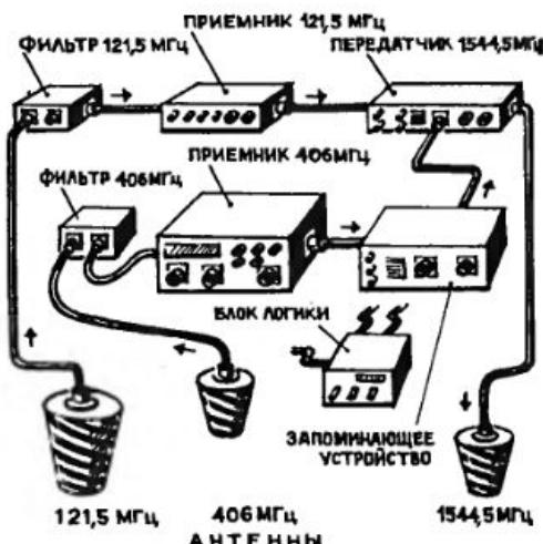
нал, вплоть до миллиардной доли микроватта. Примерно столько же приходит к наземным приемникам от космических аппаратов, путешествующих где-нибудь в районе Марса или Венеры. С таким слабым сигналом работать очень сложно, и всю систему измерений и вычислений приходится рассчитывать на то, что какая-то часть сигналов от данного аварийного передатчика не будет принята или будет сильно искажена случайными помехами.
