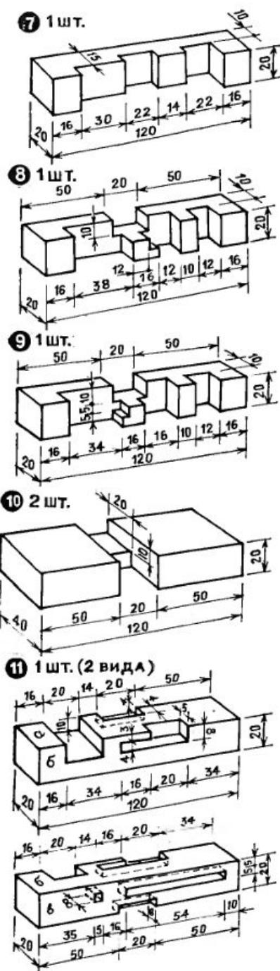
Переместив деталь 6 к себе нажатием пальца на торец (на рисунке не видно), а деталь 3 углубив в корпус куба, можно деталь 11 опустить еще на некоторое расстояние.
