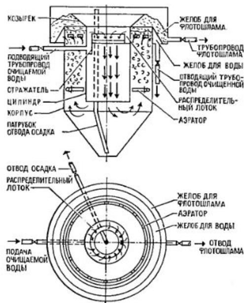
Там, где в процессе очистки сточных вод используются процессы отстаивания и флотации, широкое применение находят специальные устройства — флотоотстойники. Такой отстойник состоит из цилиндро-конического корпуса, внутри которого coaxialno расположено меньший цилиндр, и
