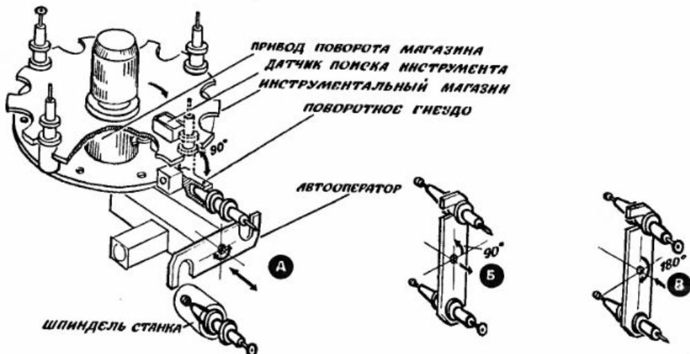
ется установить, например, на рабочий стол фрезерного станка, строго в определенном положении по отношению к инструменту, а для этого — поднять, опустить, повернуть. Все эти процедуры, включая замену инструмента, требуют от рабочего не столько квалификации, сколько физических усилий.
