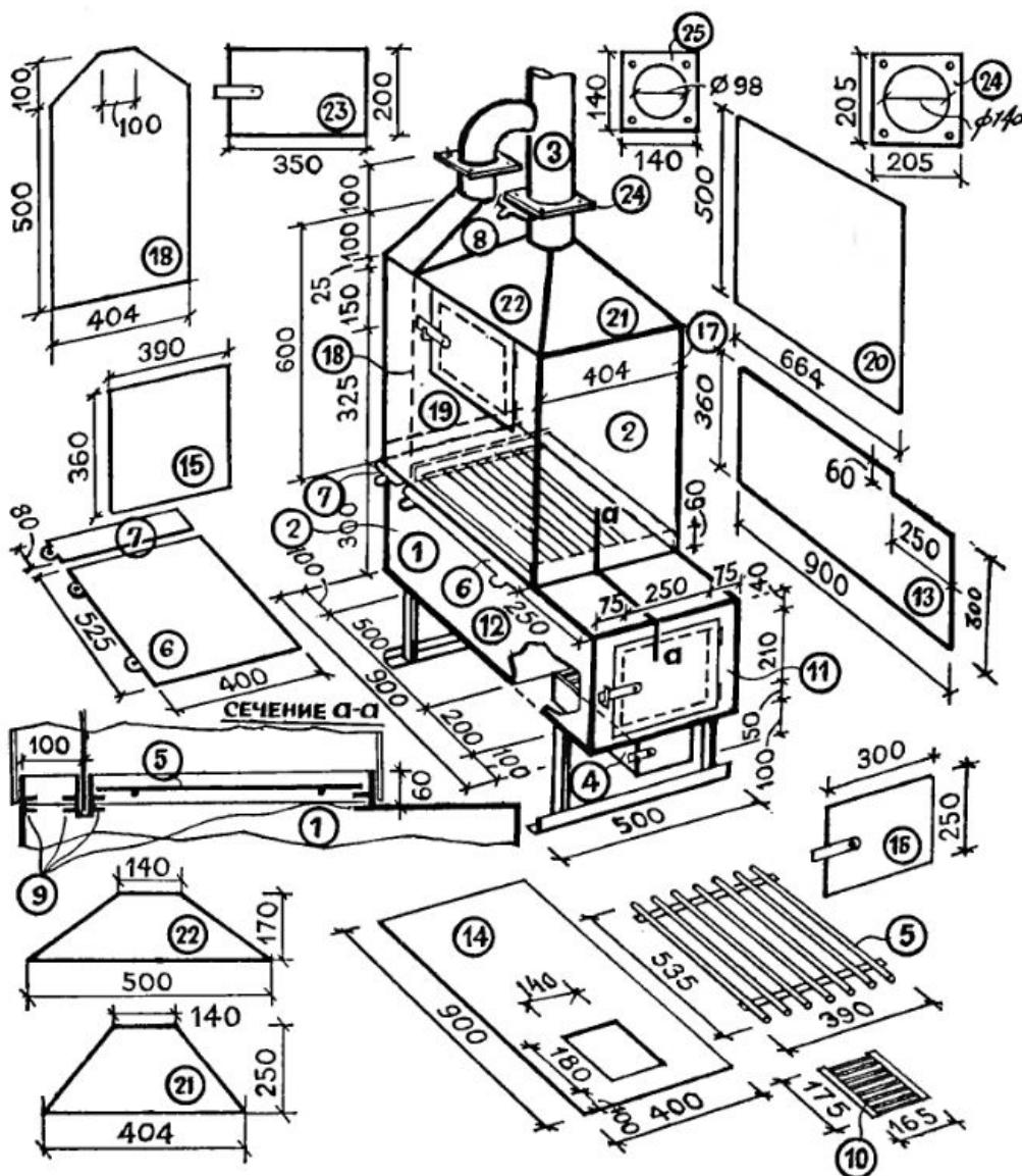
сы и, главное, в противопожарных целях сторона топки, которая обращена к деревянной стене, выкладывается изнутри кирпичом на ребро.
