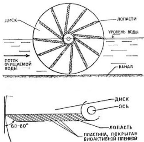
Для биохимической очистки сточных вод широко применяются каналы с вертикально установленными в них медленно вращающимися биодисками. Так называются диски, оснащенные гофрированными пластинами, покрытыми тонким (4—5 мм) слоем микроорганизмов. Эти мельчайшие живые существа способны активно
