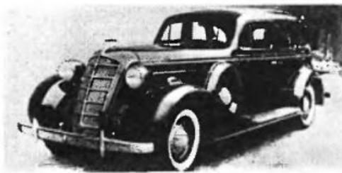
**ZIS-101 (СССР).** Представительская машина с кузовом «лимузин». Один из экспонатов советского павильона на Всемирной выставке в Париже 1937 года. Первый отечественный серийный автомобиль с двухкамерным карбюратором, синхронизаторами в коробке передач, радиоприводом и отопителем. Число цилиндров двигателя — 8. Рабочий объем — 5766 см<sup>3</sup>. Мощность — 90 л. с. (66 кВт) при 2800 об/мин. Длина машины — 5,65 м. Число мест — 7. Масса в снаряженном состоянии — 2,55 т. Скорость — 115 км/ч.
