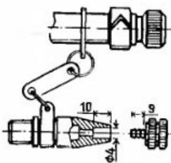
Накачать автомобильным насосом велосипедные шины — дело нескольких минут. Но вот беда — наконечник автомобильного шланга не подходит к вентилю велосипедной камеры. З. Ивасюк (с. Шипинцы) предлагает в штуцер для прокачки трубопроводов, имеющийся у автомобильного насоса, запрессовать наконечник шланга от велосипедного насоса. Таким переделанным насосом можно накачивать и автомобильные и велосипедные шины.
