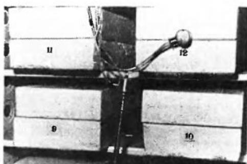
Пенопластовые блоки в камере семяхранилища. На одном из них (№ 12) установлен датчик для измерения температуры внутри блока. Ниже расположены датчики, измеряющие температуру в камере.
