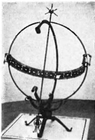
Солнечные часы из кованого железа. Часовые деления нанесены на цилиндрический циферблatt, прикрепленный к гномону.
