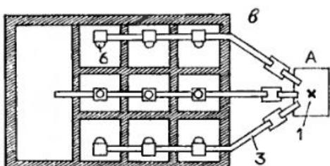
Освещение порохового цеха по методу Чиколова: а — оптическая схема; б и в — разрез и план цеха; 1 — дуговой источник света; 2 — линза; 3 — жестяная труба; 4 — полупрозрачное плоское зеркало; 5 — трубчатый отросток; 6 — рассеиватель; А — вышка.
