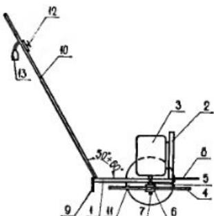
Детали газонокосилки: 1 — рама, 2 — стойка электродвигателя, 3 — электродвигатель, 4 — нож, 5 — втулка, 6 — фланец, 7 — гайка, 8 — щиток передний, 9 — защитная гребенка, 10 — ручка, 11 — колесо, 12 — выключатель, 13 — штекерный разъем.
