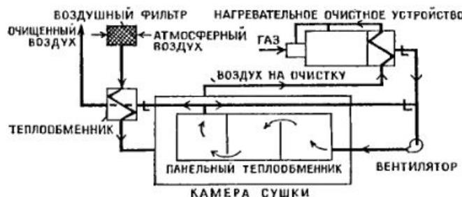
Кузов автомобиля почти готов — его остается только покрасить. Покрытый слоем краски, он поступает в сушильную камеру, где поддерживается температура 150—180°С. На ее поддержание необходимо расходовать определенную энергию.
