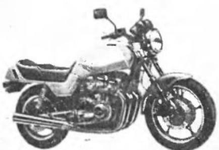
**«СУЗУКИ-GSX1100E-КАТАНА»** (Япония). Самый мощный среди мотоциклов этой марки. Особенности его конструкции: два распределительных вала в головке цилиндров, гидравлический привод передних тормозов с антиклиновой системой, дисковые тормоза обоих колес. Двигатель: число цилиндров — 4; рабочий объем — 1067 см<sup>3</sup>; мощность — 100 л. с. (74 кВт) при 8700 об/мин. Масса машины в снаряженном состоянии — 260 кг. Длина — 2,23 м. Скорость — 220 км/ч. Время разгона до 100 км/ч — 3,8 с.
