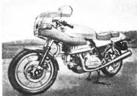
«ДУКАТИ-900S2» (Италия). Особенность машин «Дукати» — V-образное расположение цилиндров, при котором передний почти горизонтален, и десмодромный (без пружин) клапанный механизм. Двигатель: число цилиндров — 2; рабочий объем — 864 см<sup>3</sup>; мощность — 65 л. с. (48 кВт) при 7000 об/мин. Масса машины в снаряженном состоянии — 227 кг. Длина — 2,02 м. Скорость — 213 км/ч. Время разгона до 100 км/ч — 4,7 с.
