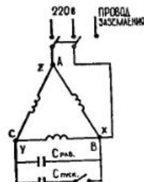
Схема включения трехфазного асинхронного двигателя в однофазную сеть. Провод заземления подсоединенется к корпусу косилки и электродвигателя.
