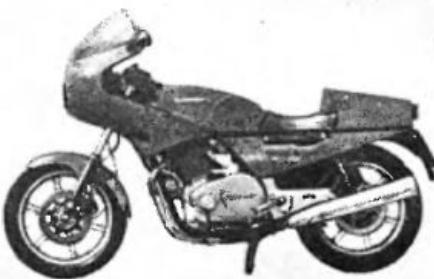
«ЛАВЕРДА-RGS1000» (Италия). Традиционная конструкция без каких-либо необычных технических решений: дуплексная трубчатая рама, пятиступенчатая коробка передач, подвеска колес установившейся за последние три десятилетия конструкции. Двигатель: число цилиндров — 3; рабочий объем — 981 см<sup>3</sup>; мощность — 83 л. с. (61 кВт) при 8000 об/мин. Масса машины в снаряженном состоянии — 265 кг. Длина — 2,20 м. Скорость — 209 км/ч. Время разгона до 100 км/ч — 4,6 с.
