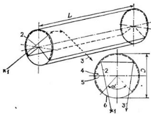
Схема, поясняющая принцип действия щелевого световода: 1 — источник света; 2 — луч, входящий в торец световода; 3 — вышедший луч; 4 — оболочка; 5 — зеркально отражающий слой; 6 — оптическая щель;  $\alpha$  — угловой размер оптической щели.
