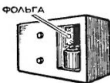
Если элемент «Марса», от которого питаются электромеханические часы, истощился, а свежего под рукой нет, его можно заменить любым другим на напряжение 1,5 В. В случае использования элемента меньших размеров надежный контакт обеспечит ластик, обернутый фольгой.
