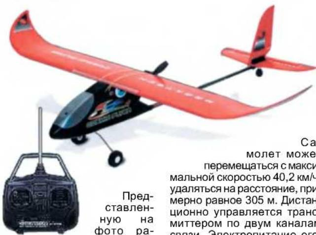
Представленную на фото радиоуправляемую модель самолета разработчики анонсируют как самую быструю из серийно выпускаемых. Американская фирма MEGATECH утверждает, что затратила годы на отработку и испытания аэродинамики модели, проверку и подбор материалов для достижения предельно малого ее веса (269,33 г). Надежность в эксплуатации летательного аппарата обеспечивают полинилоленовые конструктивные элементы и популярный Votriflo-дизайн.
