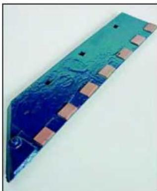
упрочнения рабочих органов пахотных орудий. На режущей кромке с помощью высокопрочного клея, сварки или наплавки укрепляют пластины из износостойчивого чугуна или керамики. В результате срок службы лемехов возрастает в 2–4 раза. Экономятся материалы и время на ремонт.
