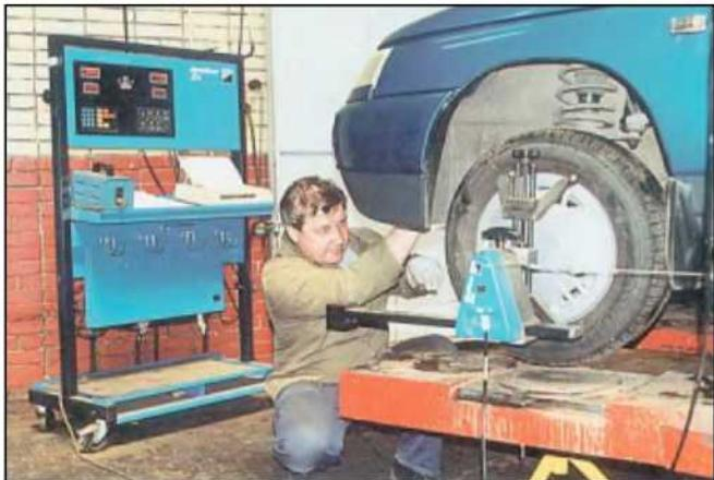
Для регулировки углов установки колес на машинах ВАЗ используются лазерные технологии.
