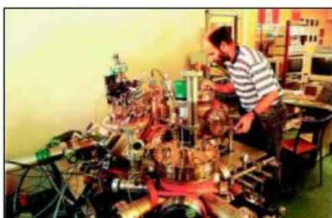
Атомно-силовой микроскоп внешне не похож ни на оптический, ни на электронный.
