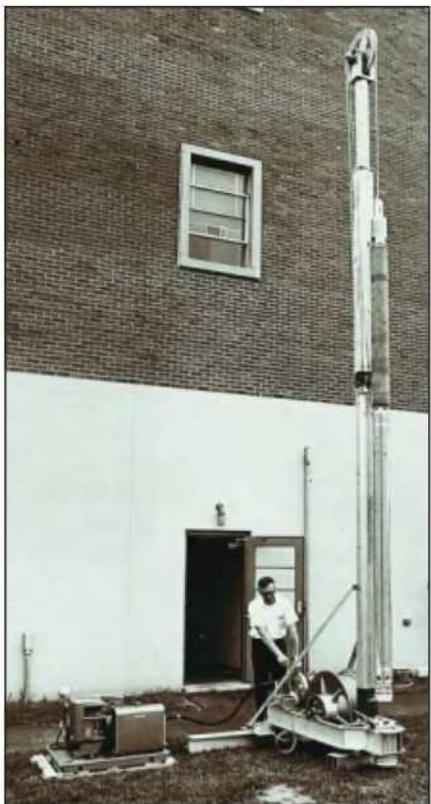
Демонстрация термобурового снаряда для бурения ледниковых скважин (американская военная лаборатория USA CRREL). За пультом управления — один из его изобретателей Д. Гарфилд (1966 год).
