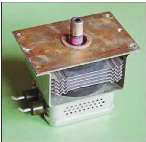
Внешний вид магнетрона — основного узла микроволновой печи.
