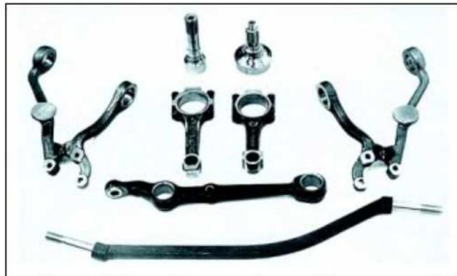
Кованые заготовки для этих деталей из микролегированной стали АЦ40ХГАФБ уже не требовали обычной закалки и отпуска перед началом механической обработки.
