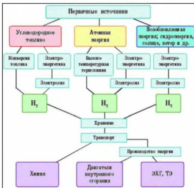
Схема получения и использования водорода в двигателях, электрохимических генераторах (ЭХГ), топливных элементах (ТЭ) и для химического производства.
