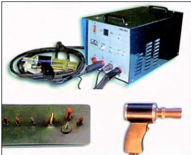
**Переносная установка УМС-601 для приварки болтов, шпилек или штифтов незаменима для быстрого и надежного изготовления кузовов автомобилей, шкафов управления, корпусов приборов и оборудования и даже декоративной отделки зданий.**
