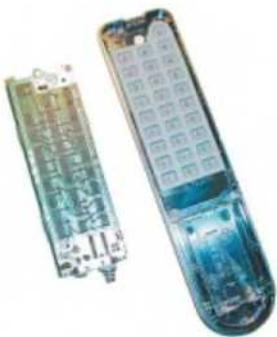
Чтобы полностью восстановить нормальную работу «засалившегося» пульта дистанционного управления телевизором, иногда достаточно вскрыть его корпус, промыть содержимое водой с мылом и как следует выслушать.
