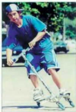
но мчаться с максимальной скоростью 25—29 км/ч. Предусмотрен тормоз на задние колеса. Рама изготавливается из высококачественного авиационного дюралюминия, колеса (диаметром 20 см) — из уретанового эластомера.
