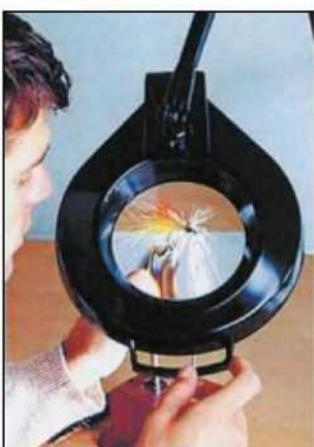
При использовании увеличительной линзы очень часто возникает необходимость в подсветке рассматриваемого предмета. Однако боковое дополнительное освещение не обеспечивает однородности светового поля в рабочей зоне и создает тени, если объект исследования имеет объемную форму. Увеличительная линза с электрической лампой освещения, окружающей оптику кольцом, лишена этих недостатков.
