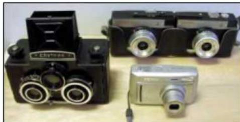
Выпускавшаяся серийно широкоформатная стереофотокамера «Спутник», самодельная стереокамера из двух фотоаппаратов «Смена» и современный цифровой фотоаппарат «Pentax Optio 33L» с режимом стереосъемки.
