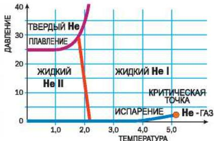
Диаграмма состояний  ${}^4\text{He}$ . При понижении температуры жидкый гелий-один с нормальными свойствами переходит в сверхтекучий гелий-два. Температура перехода слегка понижается с ростом давления — от  $2,17\text{ K}$  при давлении насыщающих паров до  $1,77\text{ K}$  при  $30$  атмосферах.
