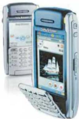
Ныне размеры переносных карманных компьютеров (КПК) уменьшились настолько, что в качестве дополнительного технического средства помещаются в беспроводной телефонной трубке. Созданные по этому принципу «сдвоенные» бытовые устройства получили наименование «смартфоны».
