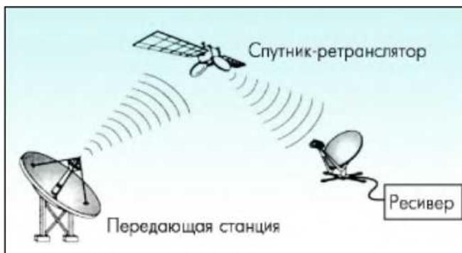
Рис. 1. Основные элементы системы спутникового телевидения.
