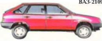
VAZ-2109   |                                 | Пятидверный хэтчбек, двигатели: карбюраторный и с электронной системой впрыска топлива |
