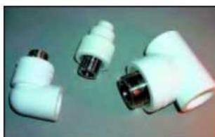
Для соединения труб и арматуры еще при их отливке в концы вставляют металлические патрубки с резьбой. Из-за разницы коэффициентов температурного расширения металла и пластмассы есть риск разрушения соединения. Но так как полипропилен при нагреве становится более пластичным, расширение трубы происходит за счет механической силы со стороны металлического патрубка.
