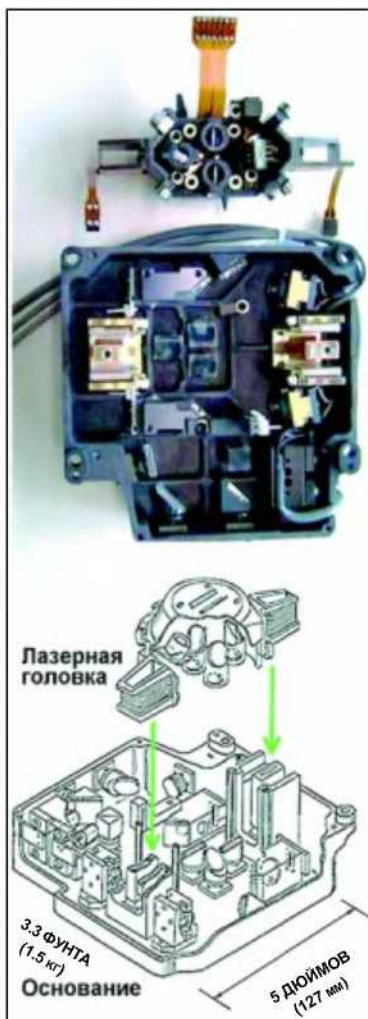
Лазерная считывающая головка проигрывателя грампластинок (фото сверху и схема).
