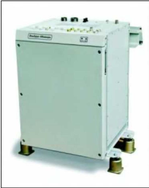
Перебазируемый вычислительный комплекс «Эльбрус-90 микро» на процессоре 0,13 мкм. Разработка 2003 года.
