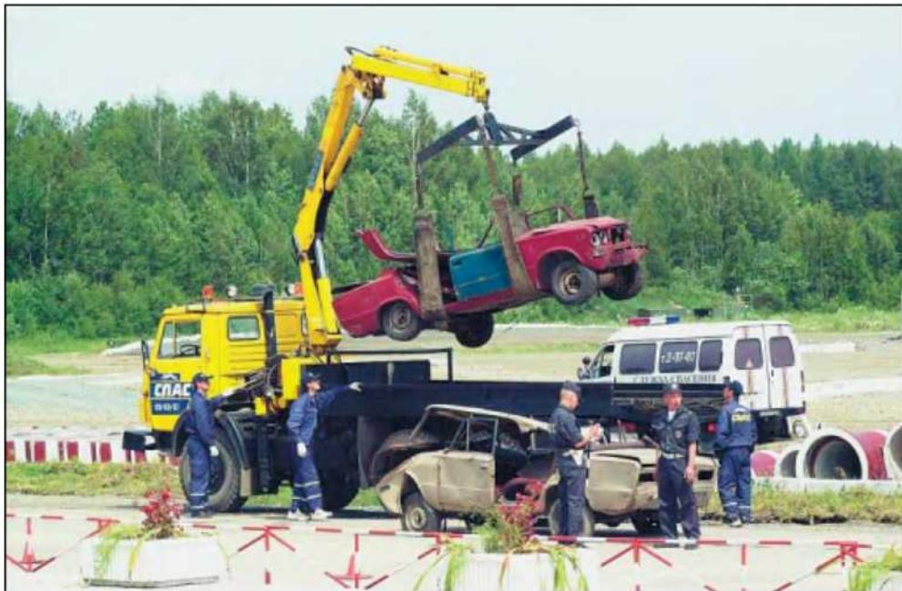
Машина инженерно-технического обеспечения «БРЭМ» эвакуирует с дороги автомобиль, поврежденный в дорожно-транспортном происшествии.
