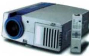
подключение тюнеров (приемников) наземного и спутникового телевидения, видеомагнитофона, DVD-плеяра, домашнего компьютера и др. Соотношение сторон экрана изображения принято равным 16:9 с диагональю в пределах от 106 до 508 см на рабочих расстояниях от 2 до 10 м. Проектор может использоваться в офисах как на презентациях, так и для текущей работы.
