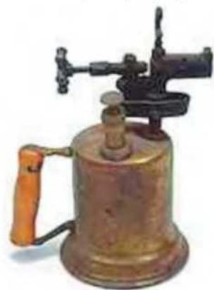
Примус действует по тому же принципу, что и паяльная лампа. На фотографии: медная паяльная лампа первой половины XX века. Пламя образуется на выходе форсунки при воспламенении смеси паров жидкого горючего (спирт, керосин, бензин) с воздухом.
