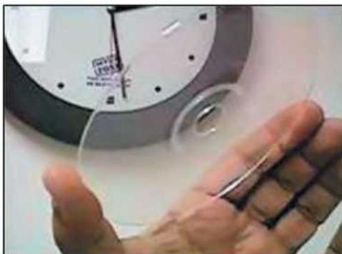
Оптический диск будущего — флуоресцентный многослойный диск (FMD) — совершенно прозрачен. Причина тому — отсутствие отражающего свет металлического слоя.
