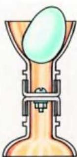
Простейшую подставку для яиц можно сделать из верхней части пластмассовой бутылки. Если же при помощи двух скрепленных винтом пробок соединить два горлышка, подставка получится очень устойчивой.
