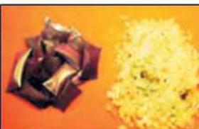
ИССЛЕДОВАНИЯ ПРОЦЕССА «ИШПО-ХТ» В РОССИИ ПОКАЗАЛИ ВОЗМОЖНОСТЬ УМЕНЬШЕНИЯ В 5—6 РАЗ ОБЪЕМА РАМОПРИХ ПРИ ПЕРЕПЛАВКЕ И ОЧИСТКИ МЕТАЛЛА НА 2—3 ПОРЯДКА ОТ ОСНОВНЫХ РАДИОНУКЛИДОВ (ПЛУТОНИЙ, УРАН, ЦЕЗИЙ, СТРОНЦИЙ, РУТЕНИЙ).
