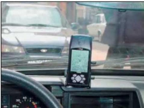
Один из компонентов спутниковой навигационной системы — навигатор фирмы «Garmin» — закрепляется на панели приборов с помощью кронштейна. На экране отображается маршрут движения автомобиля.
