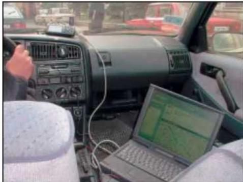
*Вариант системы спутниковой навигации в составе навигационного приемника и ноутбука.*
