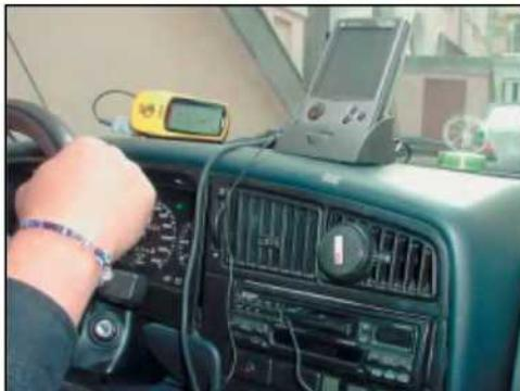
Вариант системы автомобильной спутниковой навигации в составе навигационного приемника (слева на панели приборов) и карманного персонального компьютера Cassiopeia E-115 в крэдле (подставке), подключенного к аудиосистеме автомобиля для речевого сопровождения маршрута.
