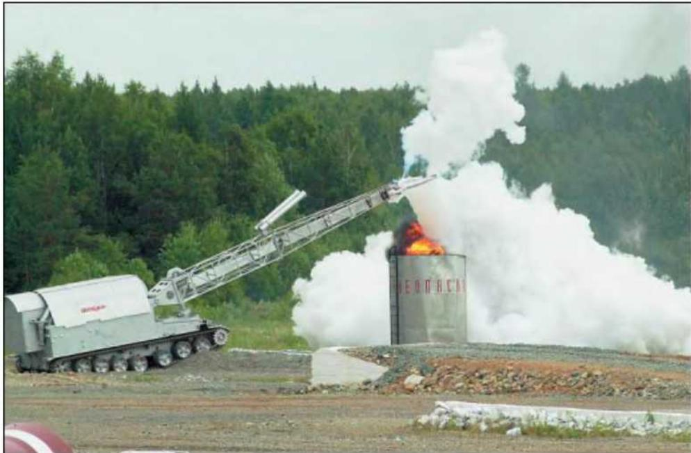
Противопожарная установка «Штурм» гасит сжиженным азотом пламя на газовой скважине всего за 3–5 секунд.
