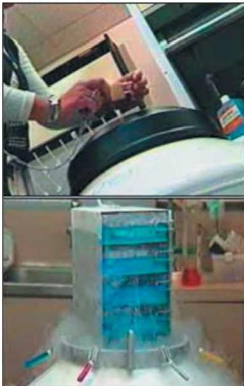
Культуры эмбриональных клеток хранят в замороженном виде при температуре кипения жидкого азота в специальных криостатах. (На верхнем снимке криостат закрыт, на нижнем — в открытом виде.)
