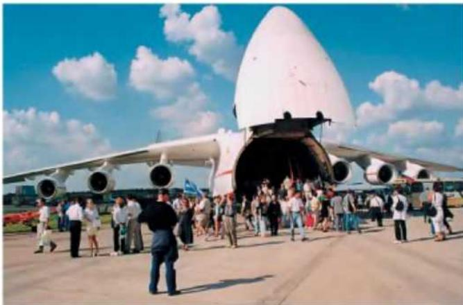
Транспортный самолет сверхбольшой грузоподъемности Антонов-225 «Мрия». Его взлетный вес — 605 тонн, максимальная коммерческая нагрузка — 250 тонн, скорость — 750—850 км/ч.
