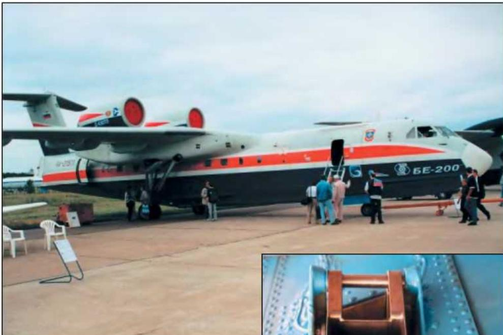
Многоцелевой реактивный самолет-амфибия Бе-200, построенный по заказу МЧС России, может применяться для пожаротушения, доставки спецкоманд, перевозки грузов. Он обладает уникальной особенностью взлета и посадки на сушу и на воду. Может заправляться водой как на аэродроме, так и осуществлять ее забор на водоеме в режиме глиссирования (12 тонн воды за 14 секунд). Вода поступает через «шлюз», который по размерам сравним с ладонью (на фото — вид снизу).
