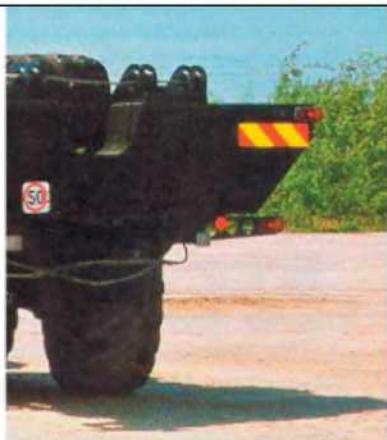
Многоосное шасси для перевозки грузов массой более 40 тонн может разворачиваться на площадке диаметром 34 метра.
