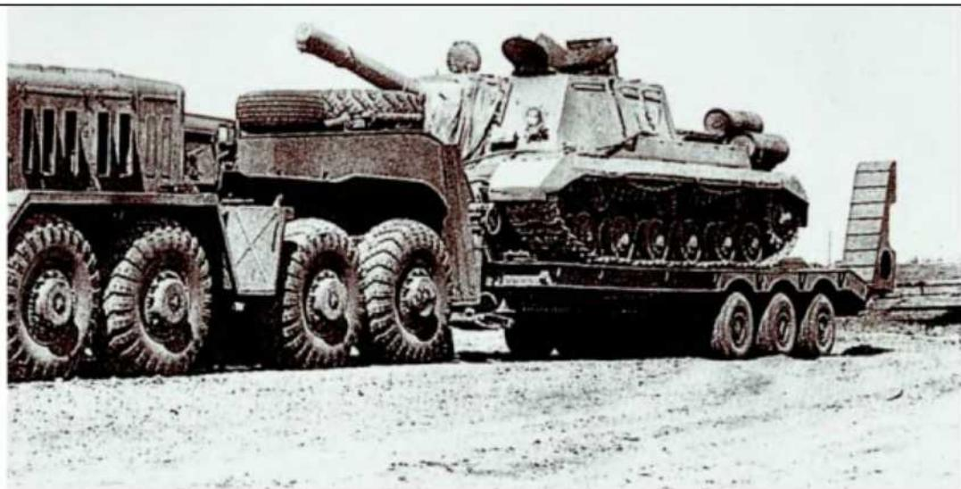
перетяжелые автопоезда ездят по обычным автомобильным магистралям и мостам, не разрушая их, потому что вес груза равномерно распределяется между всеми колесами, число которых может доходить до двухсот.
