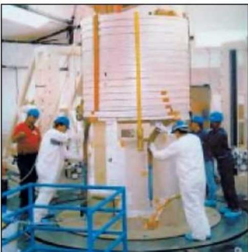
В апреле 2000 года при испытании магнитной системы на стенде было получено поле с индукцией 13 тесла при токе 46 килоампер и с запасенной энергией 640 мегаджоулей. Катушки-вставки центрально-го соленоида в этом поле успешно выдержали 10 тысяч циклов заряд—разряд при подъеме поля со скоростью 0,4 Тл/с и его снижении 1,2 Тл/с, что превышает проектные значения для ИТЭРа. Именно прогресс в технике сверхпроводников и позволил осуществить сам этот реактор.
