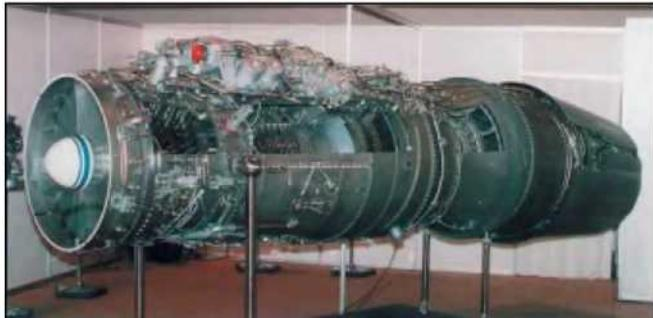
Двухконтурный турбореактивный двигатель АЛ-31Ф, установленный на Су-27.
