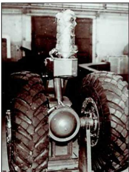
тери на переходных режимах и при транспортировке с места, улучшаются тяговые и тормозные характеристики тяжеловоза, снижаются затраты на его обслуживание. Кроме того, с электромеханической трансмиссией проще управлять большим числом колес.
