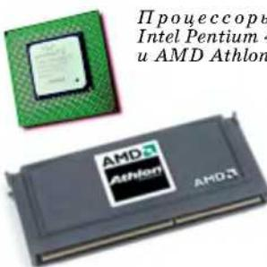
процессоров, нужно правильно выбрать **материнскую плату**. Для Pentium 4 подойдут, например, платы с набором микросхем (чипсетом) Intel-850 и VIA Pro266, а для процессора Athlon — с набором микросхем AMD-760 или 761. Желательно выбирать материнские платы известных производителей, например ASUSTeK, Abit, Gigabyte.
