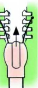
Чтобы натянуть проволоку для изгороди, подойдут толстый болт (M12 и больше) и втулка из водопроводной трубы. Во втулке и в болте просверлите по отверстию, соответствующему диаметру проволоки. Соберите конструкцию, как показано на рисунке. Натягивать проволоку нужно гаечным ключом за головку болта, а фиксировать конструкцию — гайкой. Если проволоку нужно натянуть очень туго, можно дополнительно зафиксировать головку болта проволочной петлей.
