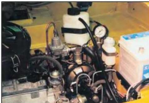
В моторном отсеке автомобиля «Мишка» в отличие от «Оки» компонуется полноценный мотор ВАЗ-21081.
