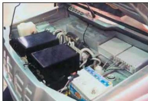
Размещение тягового электрооборудования под капотом электромобиля.
