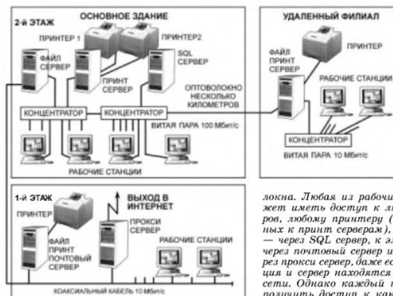
Пример большой локальной сети в двухэтажном учреждении, состоящей из трех сегментов:
