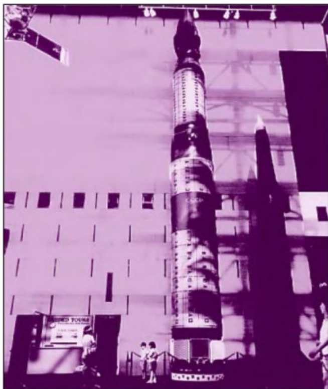
Модель системы аварийного спасения экипажа «Союз». По заданию С. П. Королева на ней отрабатывалась аэродинамика и проводились занятия с космонавтами.
