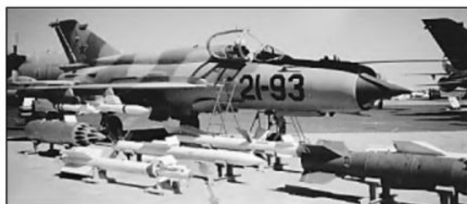
В комплект авиационного вооружения самолета МИГ 21-93 входит ракета с решетчатыми рулями и стабилизаторами (слева в середине). Фото с Международного авиакосмического салона, прошедшего в Абудаби в 1995 году.
