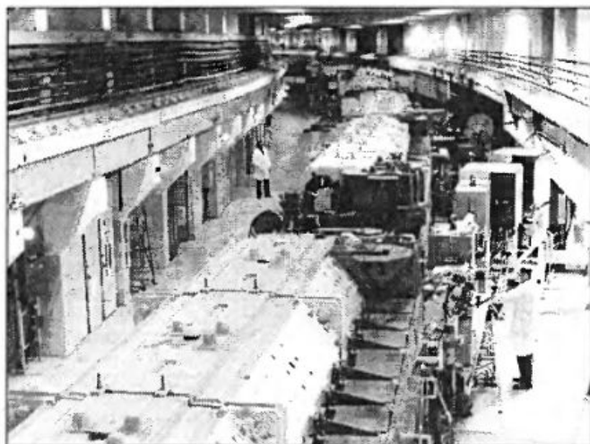
Кольцевой зал крупнейшего в России ускорителя У-70. Получив пучок протонов с энергией 1,5 ГэВ из синхротрона (канал, подводный частицы, виден справа), ускоритель разгоняет их до энергии 70 ГэВ. Ускоритель У-70, в свою очередь, будет служить ступенью, источником предварительно ускоренных протонов для УНК.
