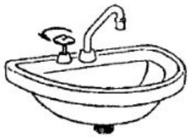
1. Перекройте вентиль на стояке и проверьте отсутствие горячей или холодной воды в ремонтируемом вентиле, открывая кран в ванной.
