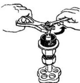
3. Отверните гайку плоскогубцами или гаечным ключом.
