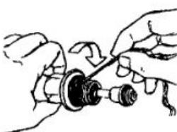
6. Удалите размокшее или продавленное уплотнение с головки корпуса. Намотайте конусообразно нитяное уплотнение так, чтобы первые две-три нитки резьбы оставались открытыми (без уплотнения).
