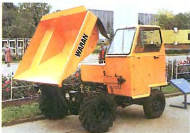
Автопогрузчик «Варан» невелик, но берет полторы тонны сыпучего груза.
