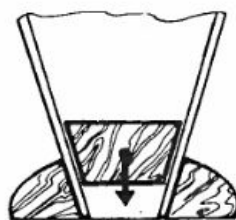
Полотно крепится к основанию с помощью конусовидной заглушки.
