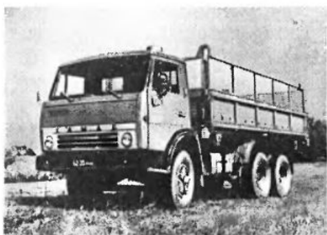
КАМАЗ-55102 (с 1981 г.). Сельскохозяйственный дизельный самосвал. Особенности конструкции: восьмицилиндровый дизель, 10-ступенчатая трансмиссия, блокируемый межосевой дифференциал. Рабочий объем двигателя — 10850 см 3 . Мощность — 210 л. с. (155 кВт). Длина машины — 7,57 м. Масса в снаряженном состоянии — 8,48 т. Грузоподъемность — 7 т. Скорость — 80 км/ч.
