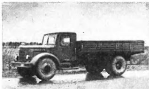
ЯАЗ-200 (1947—1950 гг.). Первый советский дизельный грузовик. Выпущена сначала на ЯАЗе, а затем на МАЗе. Машина имела двухтактный дизель, пятиступенчатую коробку передач и тормоза с пневматическим приводом. Рабочий объем двигателя — 4650 см 3 . Мощность — 110 л. с. (81 кВт). Длина машины — 7,62 м. Масса в снаряженном состоянии — 6,5 т. Грузоподъемность — 7,0 т. Полная масса буксируемого прицепа — 9,5 т. Скорость — 65 км/ч.
