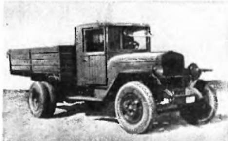
ЗИС-5 (1942—1950 гг.). Производство ЗИС-5 было начато в 1933 году, и после многих модернизаций машина выпускалась до 1963 года. Упрощенный вариант военных лет изготавливали автомобильные заводы в Москве, Ульяновске и Миассе. Рабочий объем двигателя — 5555 см 3 . Мощность — 77 л. с. (56 кВт). Длина машины — 6,06 м. Масса в снаряженном состоянии — 3,0 т. Грузоподъемность — 3,0 т. Скорость — 60 км/ч.
