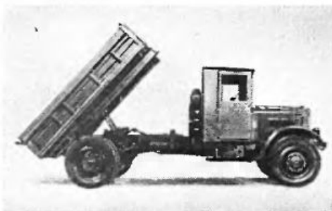
ИС-1 (1934—1936 гг.). Первый советский самосвал серийного производства. Выпускался Ярославским автомобильным (ныне моторный) заводом на шасси грузовика ЯГ-4. Изготовлено около 600 таких машин. Рабочий объем двигателя — 5555 см 3 . Мощность — 73 л. с. (54 кВт). Длина машины — 6,24 м. Масса в снаряженном состоянии — 5,82 т. Грузоподъемность — 4,0 т. Скорость — 40 км/ч.
