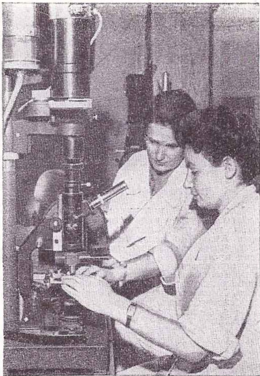
Ультрафиолетовый флюоресцентный микроскоп
