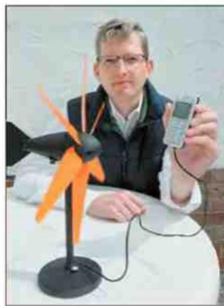
телефонии разработан миниатюрный ветряк для зарядки сотовых телефонов. Он весит всего 150 граммов, при хорошем ветре даёт полватта мощности и заряжает телефон за один-два часа.
