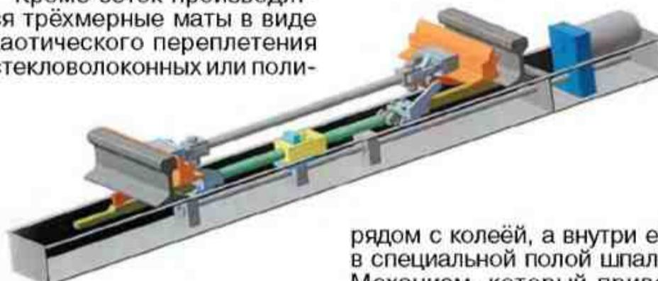
рядом с колеёй, а внутри её, в специальной полой шпале. Механизм, который приводится в действие электродвигателем постоянного или переменного тока, развивает усилие до 6,5 кН и обеспечивает ход шибера от 120 до 220 мм. На перевод стрелки требуется от 3 до 7 с.
