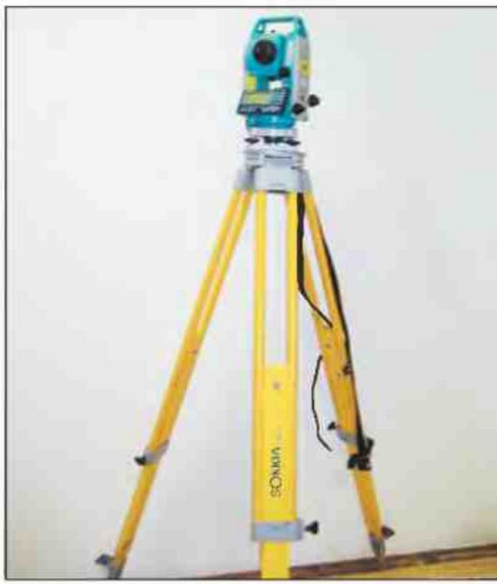
С помощью электронного тахеометра можно установить координаты объекта с высокой точностью: погрешность по углу составляет 2 угловые секунды, а погрешность по дальности — десятые доли сантиметра.
