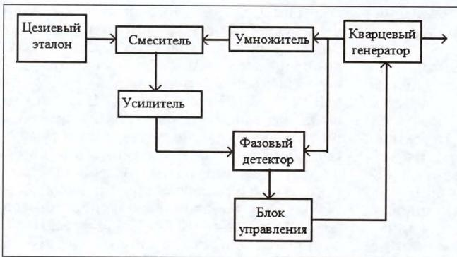
*Схема стабилизации кварцевого генератора с цезиевым эталоном частоты.*
