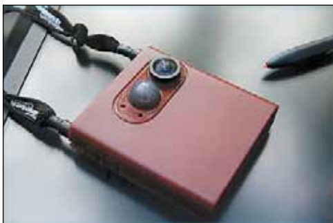
Камера SenseCam размером не более мобильного телефона. Её носят на шее, и она сама время от времени делает очередной кадр. Устройство оказалось полезным для туристов и людей с плохой памятью.
