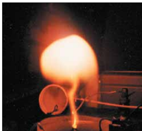
Моделирование лидера линейной молнии и образования шаровой молнии при его остановке.
