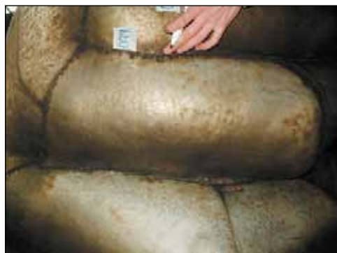
После компьютерной обработки на фотографии элемента памятника (справа) «проявляются» участки, поражённые коррозией.
