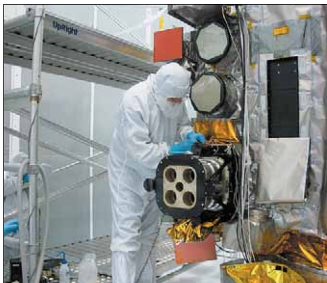
Монтаж российского прибора ЛЕНД к аппарату ЛРО. Фото НАСА.
