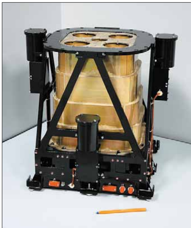
Прибор ЛЕНД для обнаружения водорода в лунном грунте имеет небольшой размер. Сравните с размером карандаша, лежащего рядом с прибором. Фото ИКИ РАН.
