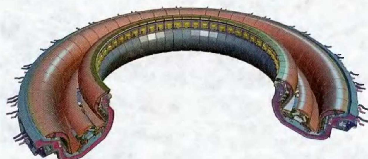
конструкции реактора внизу вакуумного объёма. Она отводит тепло от плазмы и позволяет удалять из неё гелий, образующийся в результате термоядерных реакций.
