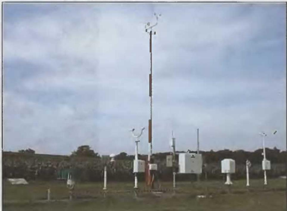
Автоматическая метеостанция в США. Измерения параметров воздуха и суши передаются в региональную службу погоды в постоянном режиме.
