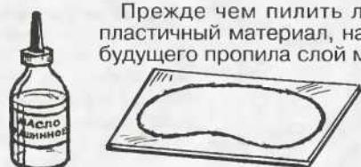
Прежде чем пилить лобзиком термопластичный материал, нанесите на контур будущего пропила слой машинного масла. Оно не позволит пилке спаяться с разогретой трением пластмассой.
