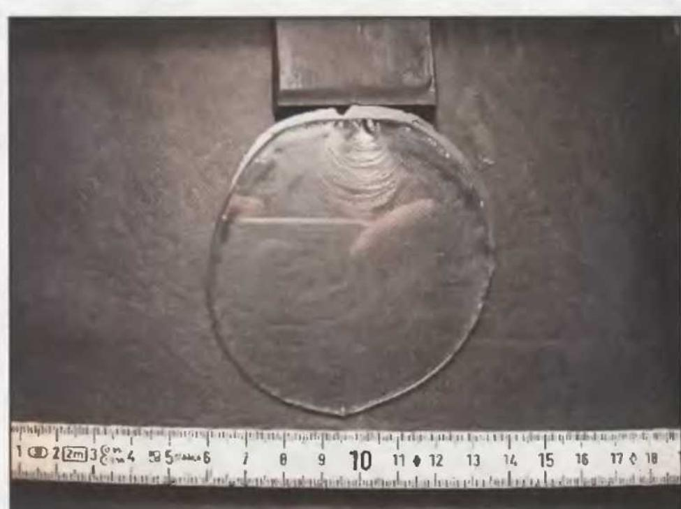
**Рис. 8.** Стеклянный диск, выбитый шаровой молнией из оконного стекла.
