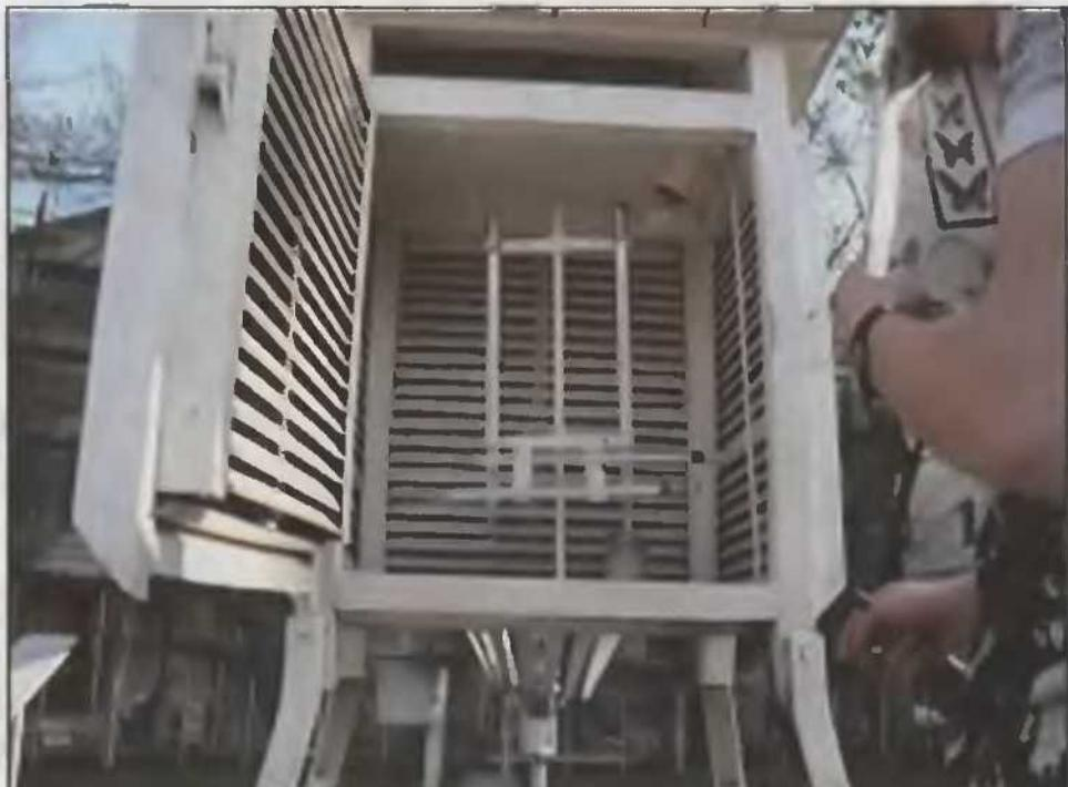
Такие будки установлены на метеостанциях всего мира. Белые, чтобы не нагревались на солнце, с отверстиями в корпусе, чтобы измерять температуру окружающего воздуха.
