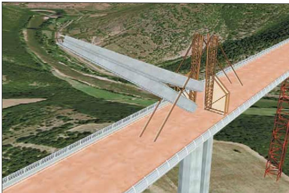
*При укладке полотна между пилонами устанавливали временные вспомогательные опоры, чтобы очередная, ещё незакреплённая секция не рухнула вниз.*
