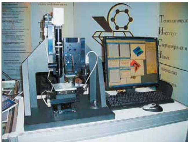
Прибор также способен воспроизводить изображение поверхности образца на квадратном участке со стороной 100 мкм (фото 1б); его чувствительность в горизонтальном направлении составляет 1 нм, а в вертикальном — 0,1 нм.
