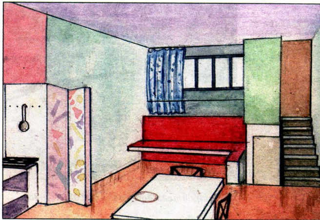
Один из вариантов планировки квартиры в доме Наркомфина — жилая комната с кухонным элементом и спальня.
