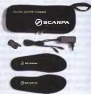
лей зимних видов спорта. Термостат поддерживает температуру, заданную с пульта дистанционного управления (на снимке он слева от зарядного устройства). Пульт позволяет также включать и выключать подогрев. Если в обувь проникнет влага, электроток автоматически отключается, чтобы избежать замыкания, а после просушки работа стелек возобновляется. Заряда встроенного аккумулятора хватает на 7 часов подогрева.
