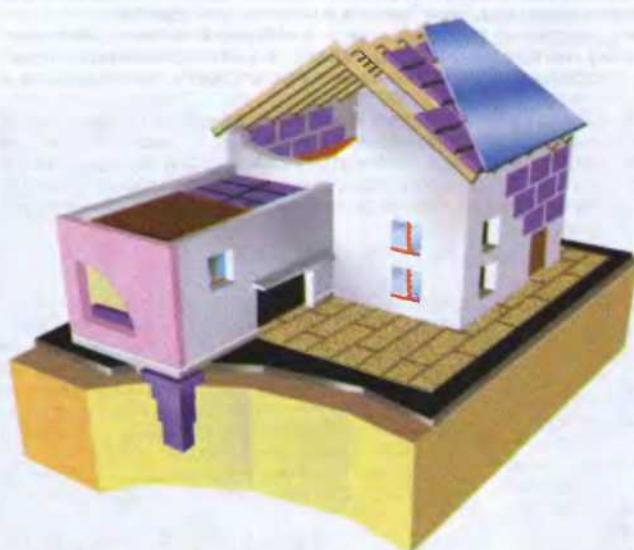
Пеностекло можно использовать для теплоизоляции наружных и внутренних стен, кровель, межэтажных перекрытий. Годится оно и для изоляции подземных частей сооружений и даже для создания современных дорожных покрытий.
