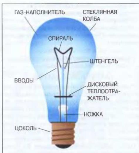
колбу она мутнеет и со временем яркость существенно снижается. Индекс цветопередачи примерно равен 90%, в спектре свечения преобладают жёлтые тона, это напоминает солнечный свет, что многим нравится. Подавляющее большинство ламп выпускается с цоколями E27 (обычные резьбовые с диаметром резьбы 27 мм) и миньон — E14 (резьбовые с диаметром 14 мм). Встречаются и другие цоколи, но назвать их массовыми никак нельзя.
