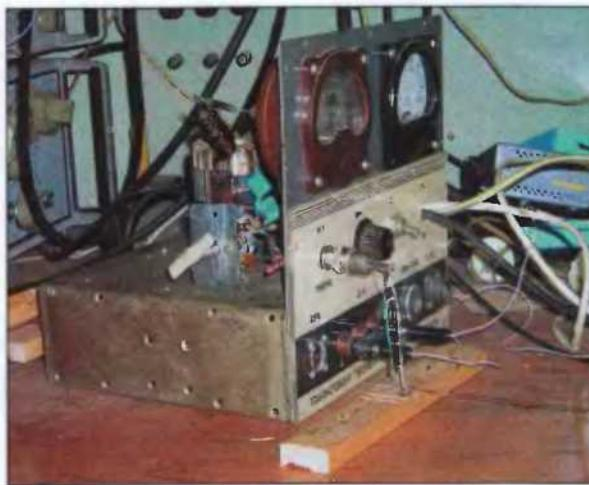
Экспериментальный генератор на 100 МГц мощностью 30 Вт, собранный в МИРЭА.
