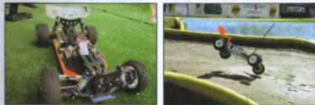
*Чтобы машины адекватно управлялись, на них предусмотрен весь спектр настроек подвески: от жёсткости пружин и амортизаторов до угла атаки рычагов, схода/развала и ходов подвески.*
