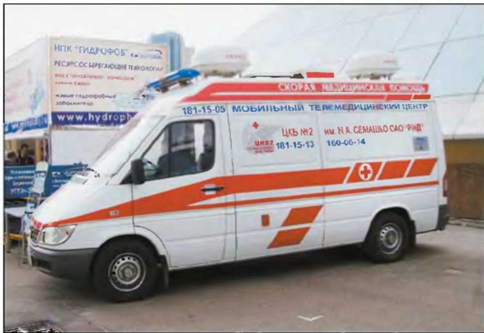
на Красной Пресне. Это машина «скорой помощи», оборудованная средствами спутниковой связи и антennами, расположенными на крыше (фото вверху). Находящаяся на борту диагностическая аппаратура подключена к ноутбуку (фото внизу; рядом с ударопрочным корпусом ноутбука показаны спутниковые антенны), укомплектованному также цифровой видеокамерой или веб-камерой.
