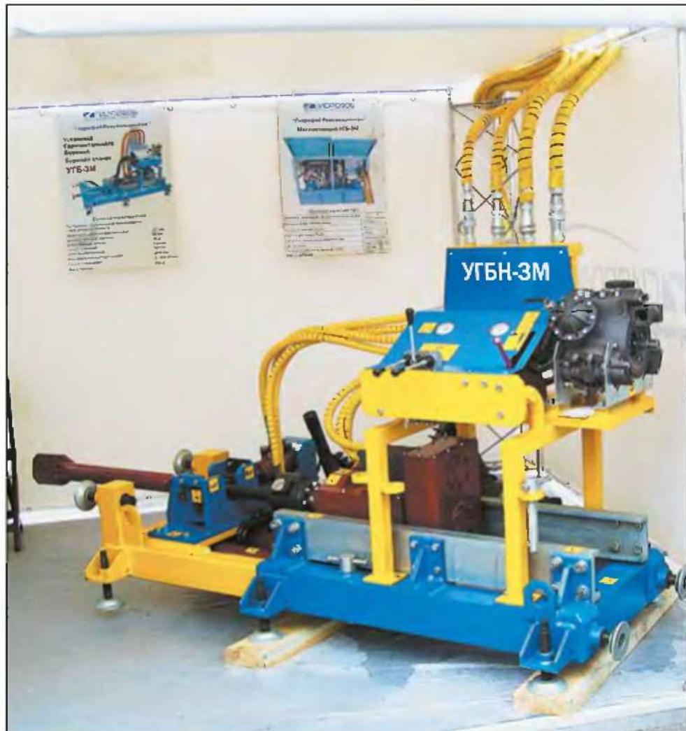
специалисты из Волгодонска разработали установку горизонтально направленного бурения УГБН. Она состоит из направленного бурового станка с гидравлическим приводом и насосной установки, которая подаёт в гидродвигатели масло под высоким давлением и воду для смазки и охлаждения инструмента.
