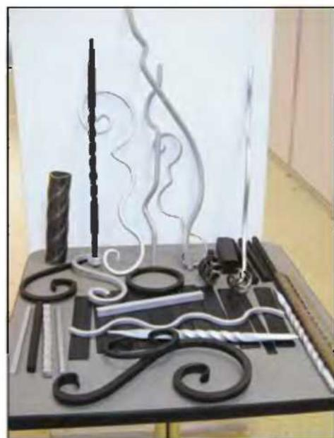
На станке «Декор-1» изготавливают изделия из прутков: завитки, кольца, корзинки. На нём же делают завершения в виде пики или лапки. Станок «Декор-2» предназначен для накатки на металлической поверхности рельефных орнаментов. На гидравлическом штампе «Декор-3» выдавливают прутки различной формы для оград и лестничных перил.
