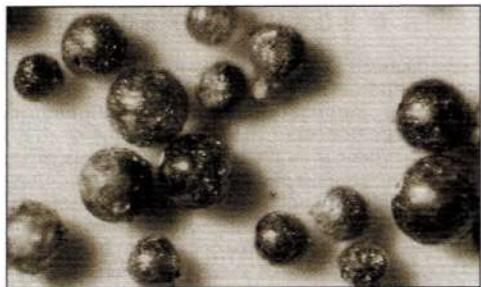
Магнетитовые микрошарики под микроскопом (отражённый свет).
