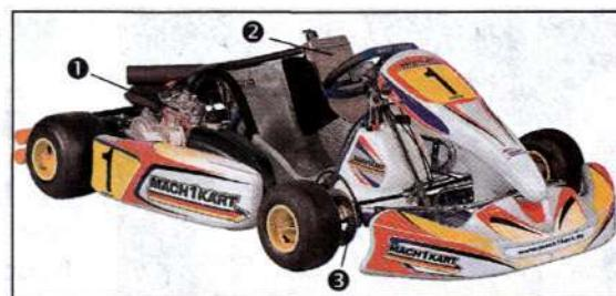
*Карт категории ДД 2. На этой мощной современной машине двигатель (1) с водяным охлаждением установлен непосредственно на задней оси. Слева за сиденьем пилота размещён радиатор (2). На передних колёсах установлены дисковые тормоза (3). Это редкость, на большинстве картов тормоза есть только на задних колёсах.*
