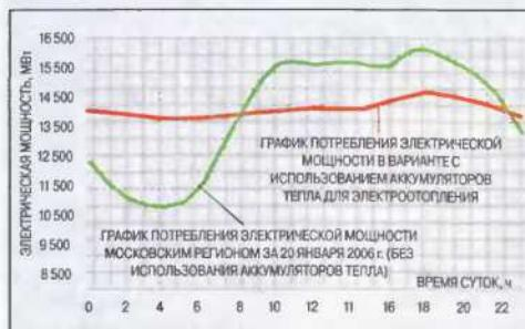
Возможность выравнивания графика нагрузки при переходе на электроотопление с накоплением тепла в ночное время: 1 — график потребления электрической мощности Московским регионом за 20 января 2006 года; 2 — гипотетический график потребления электрической мощности в случае полного перехода на ночные аккумуляторы тепла.
