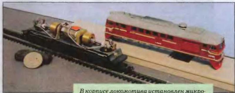
*В корпусе локомотива установлен микродвигатель размером с монету, способный обеспечить движение в обе стороны.*
