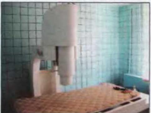
Магнитокардиографы, разработанные в ИРЭ РАН и НПО «КРИОТОН», не требуют специального оборудования и магнитной экранировки помещения, чем принципиально отличаются от зарубежных аналогов.
